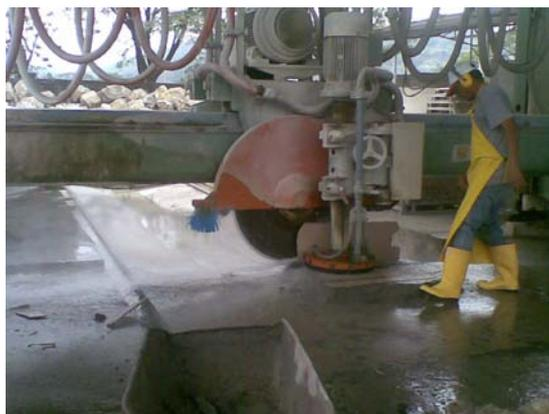
**Ilustración 27: Cortadora de mármol en piedra**
