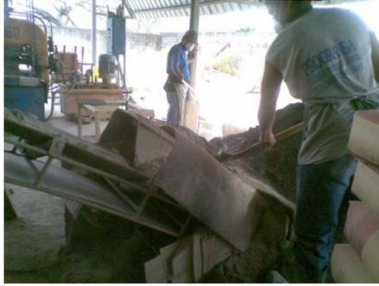
**Ilustración 6: Obreros colocando materia prima en dosificador**
