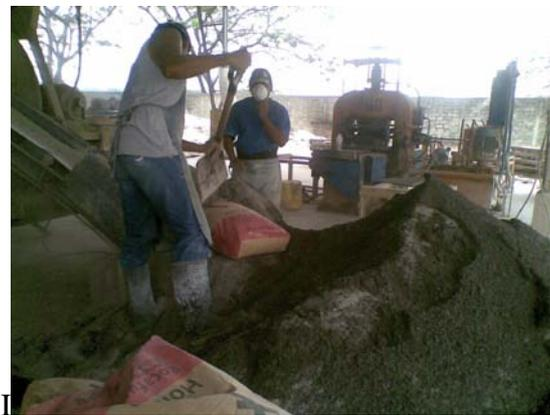
**Ilustración 5: Obreros realizando mezcla para la primera capa de baldosas
