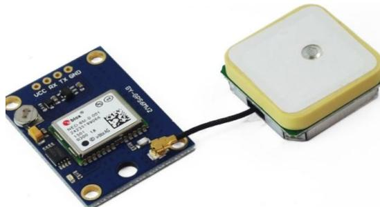
Figura 1.8 Modulo GPS NEO-6M.
