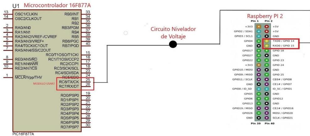
Figura 2.11 Comunicación serial PIC 16F877A y Raspberry Pi 2
