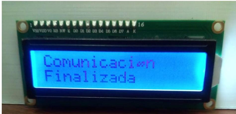
Figura 3.6: Finalización de la comunicación entre el panel de alarma y prototipo
