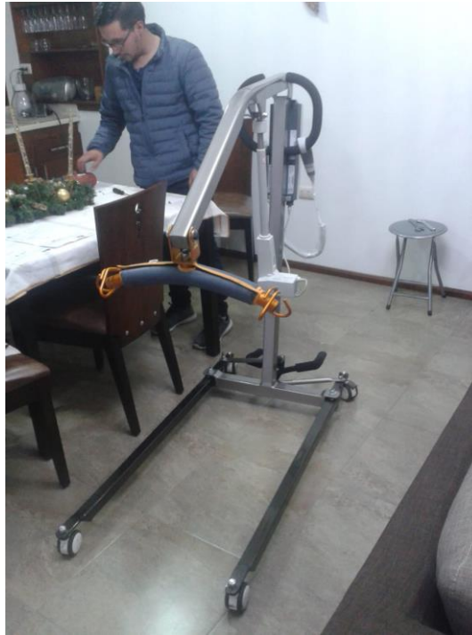
Figura 64 Grúa de transferencia terminada.
