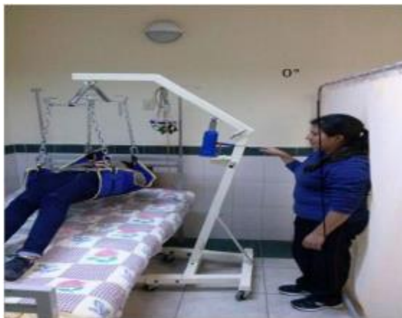
Figura 8 Mecanismo tipo grúa para transferencia de personas con discapacidad [23].
