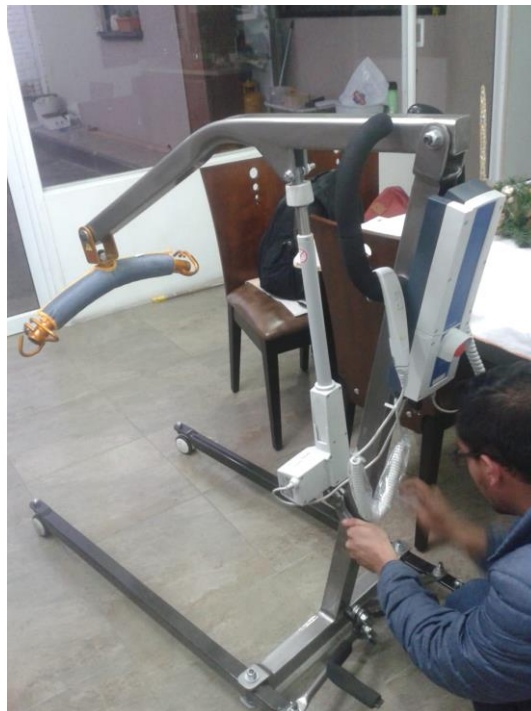
Figura 63 Ensamblaje de actuador, baterías y controlador.
