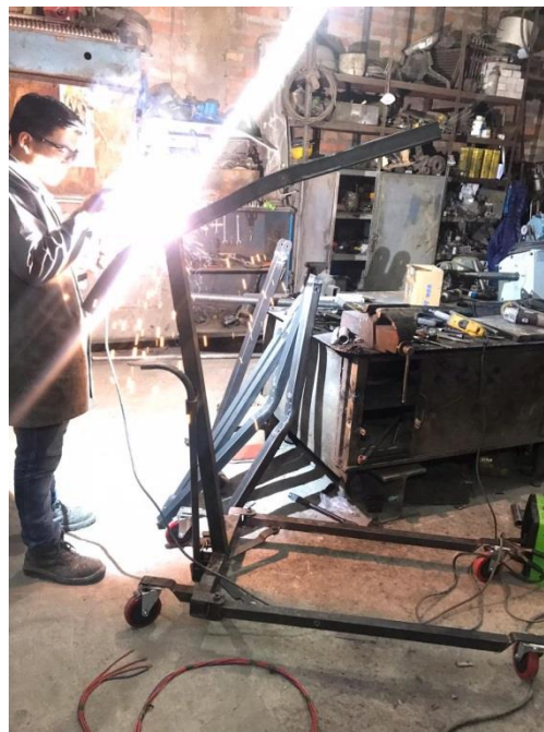
Figura 56 Construcción de grúa de transferencia.
