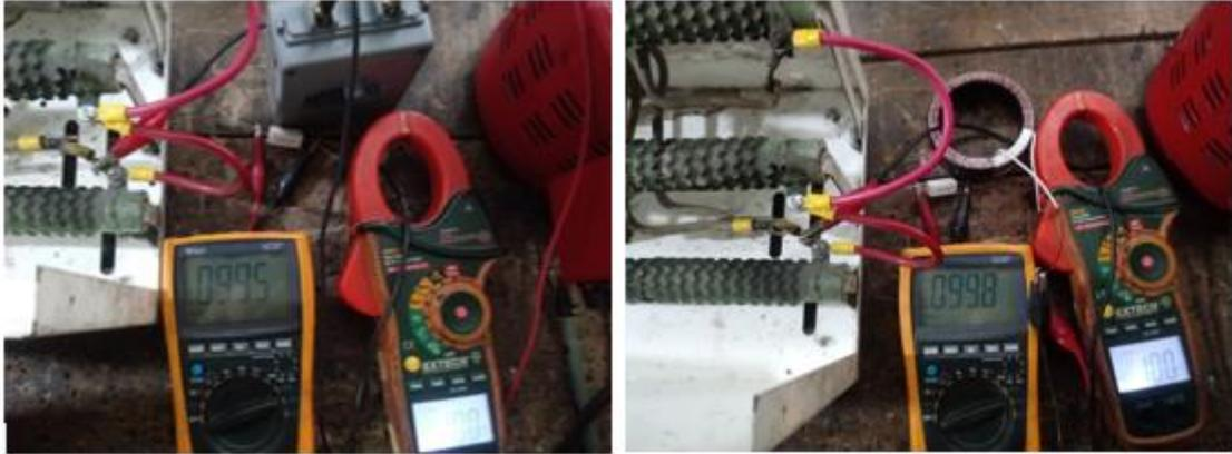
Medición de las corrientes en la prueba de funcionamiento de los transformadores de corrientes. Elaborado por: Santiago Carrión.
