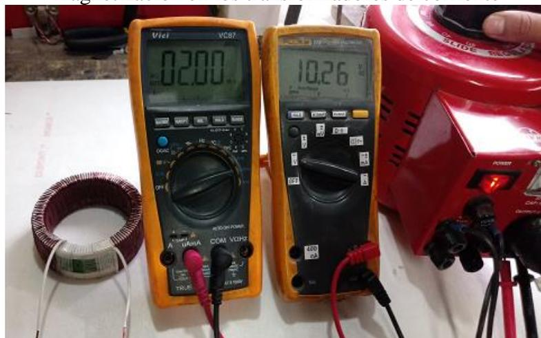
Medición de la corriente de magnetización. Elaborado por: Santiago Carrión.
