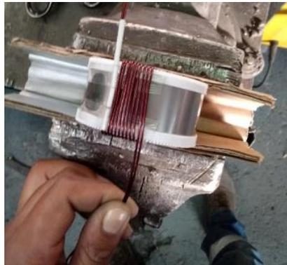
Bobinado sobre el núcleo toroidal. Elaborado por: Santiago Carrión.
