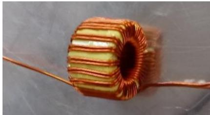
Bobinado en transformador tipo toroidal. Elaborado por: Santiago Carrión.
