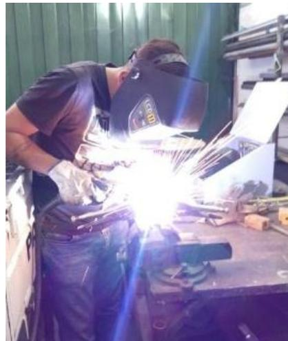
Puntos de suelda sobre el fleje laminado. Elaborador por: Santiago Carrión.
