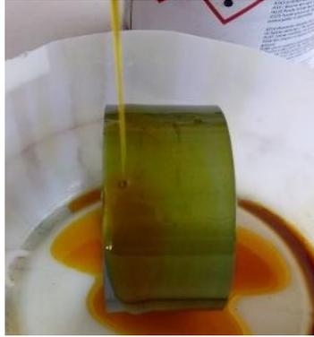
Colocación de barniz aislante sobre el núcleo. Elaborado por: Santiago Carrión.
