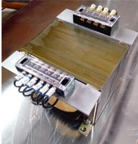
Transformador con bobinados separados. Elaborado por: Santiago Carrión.
