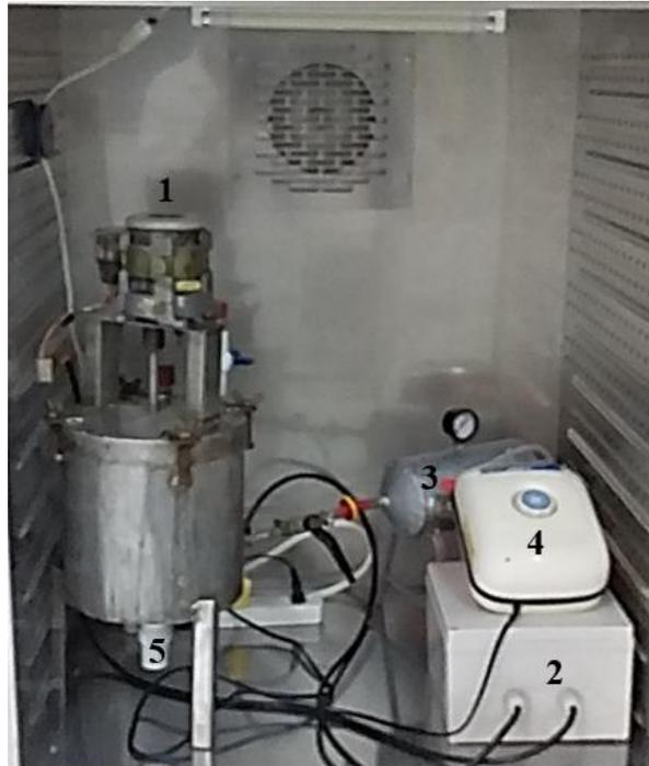
Figura 18. Biorreactor y sus partes dentro de la cámara climática.
