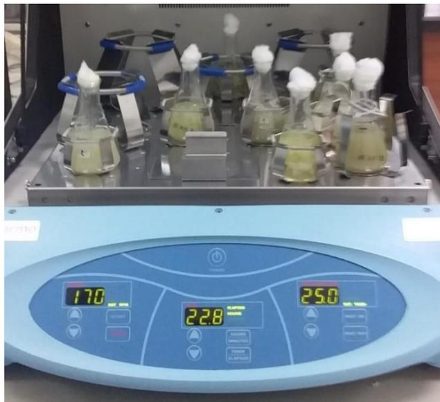
Figura 16. Fermentación de los diferentes tratamientos en una incubadora con agitación.
