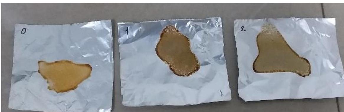
Figura 20. Precipitado después de 24 horas a 105 °C.
