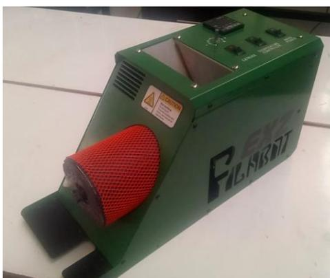
**Figura 22.** Extrusora de filamento Filabolt. **Fuente:** Autor.
