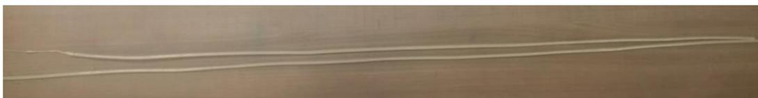
**Figura 23.** Filamento extruido para ingresarlo a la impresora 3D. **Fuente:** Autor.
