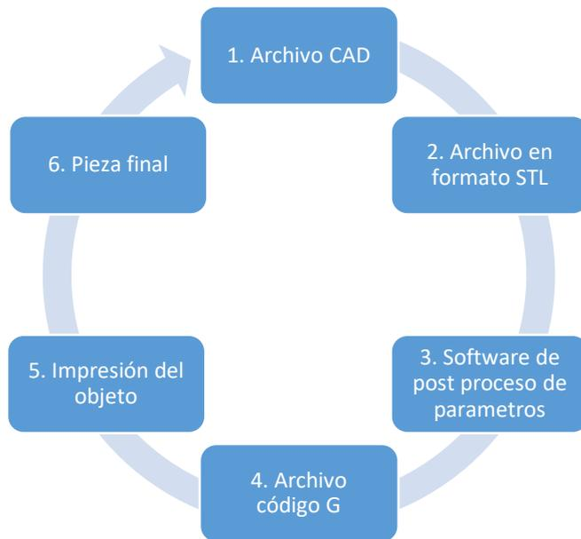
**Figura 3.** Proceso de impresión. **Fuente:** [29].
