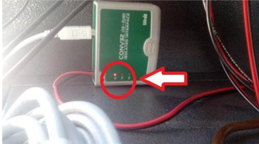
4. Encender los datalogger, que permitirá censar las temperaturas desde el sensor 1 al sensor 20, ubicados en la placa del evaporador, en los períodos de tiempo establecidos para hacer las pruebas.
