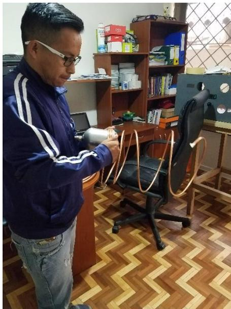
**Figura 42.** Moldeado de tubería para condensador.
