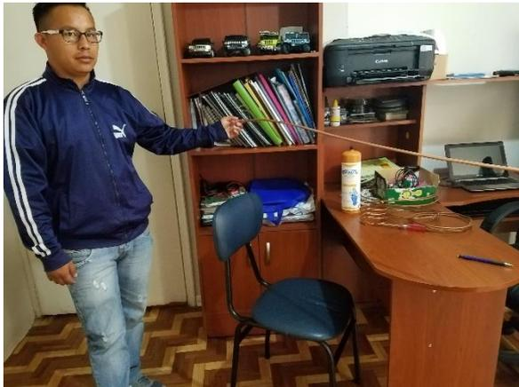
**Figura 41.** Medición y corte de tubería para evaporador.
