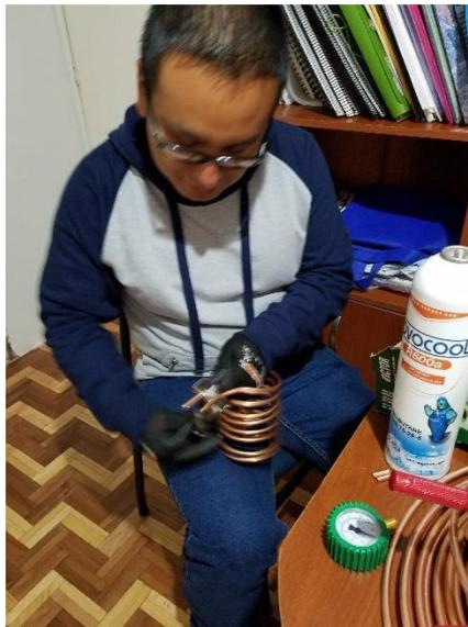
**Figura 44.** Colocación de válvulas en las terminales de la tubería.
