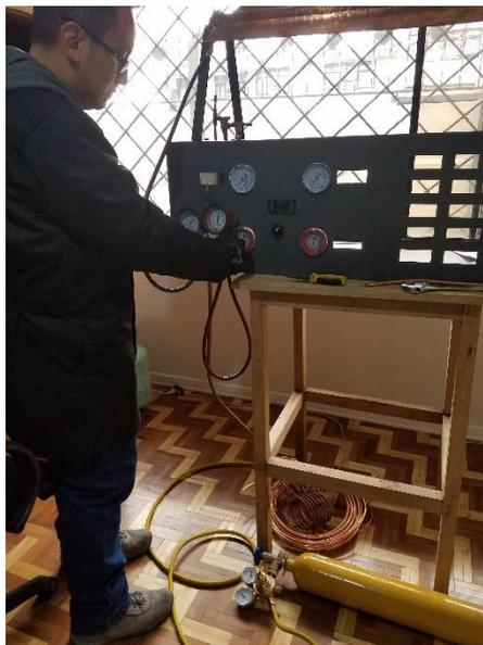
**Figura 54.** Inspección de presión en el compresor.
