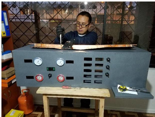
**Figura 47.** Acople de tubería en paneles del evaporador.
