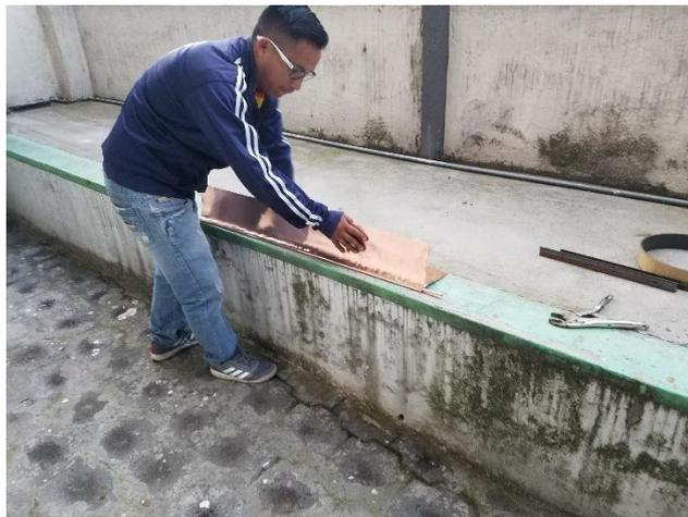
**Figura 48.** Doblado de paneles del evaporador.
