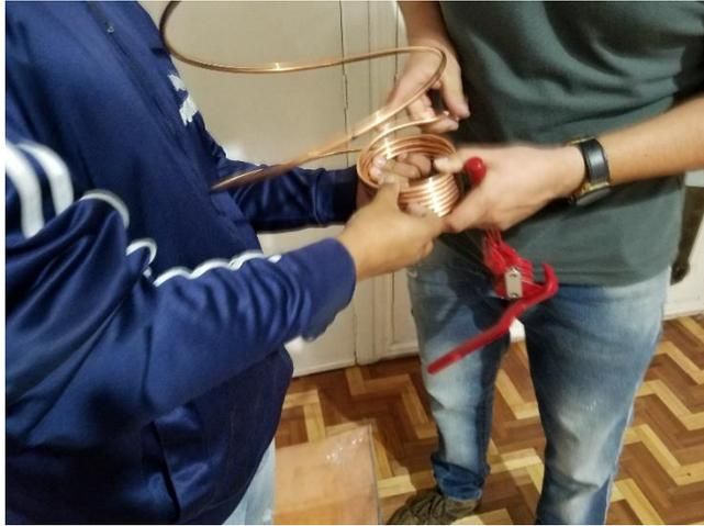
**Figura 43.** Utilización de herramienta para moldear la tubería.
