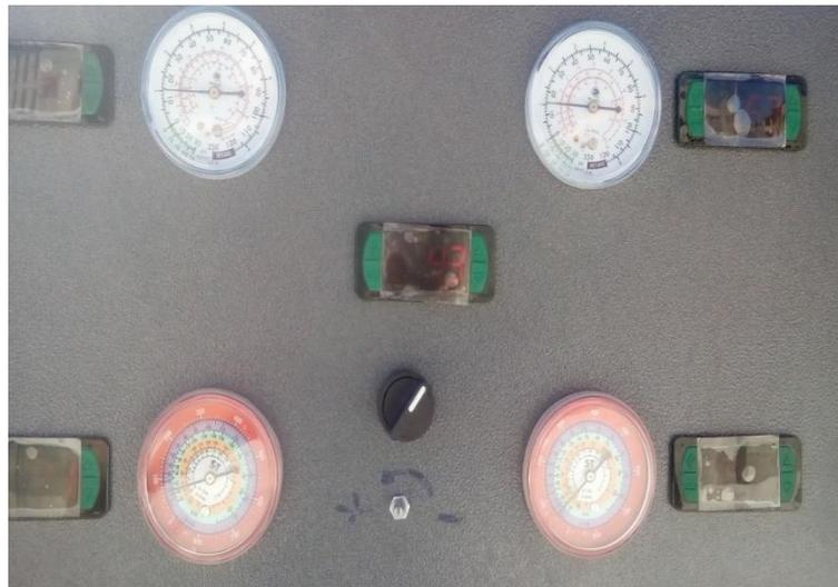
7. Llenar el recipiente del condensador con agua y encender el datalogger ubicado en el centro de los manómetros, para que cense la temperatura del líquido.
