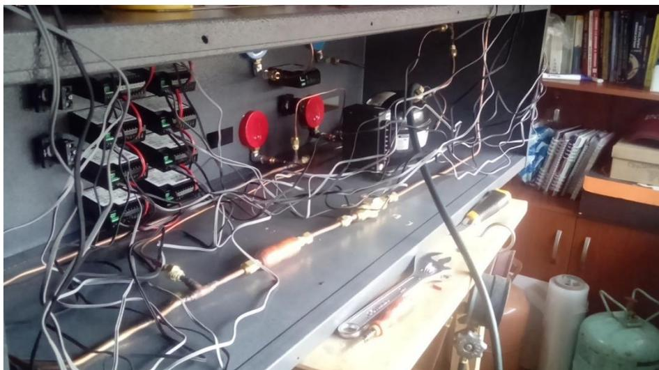
6. Verificar el estado de los sensores en toda la máquina, de presentar averías o descomposición en algún sensor, se debe arreglar con la cinta adhesiva de color plomo y la cinta aislante.
