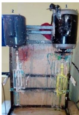
Motor 1 en buen estado de conservación. Motor 2 deteriorado. Elaborado por: Steven Gordillo.
