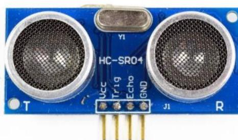
Sensor ultrasónico “HC-SR04” para medir el nivel de la gelatina. Fuente: (BestElectronics, 2018)
