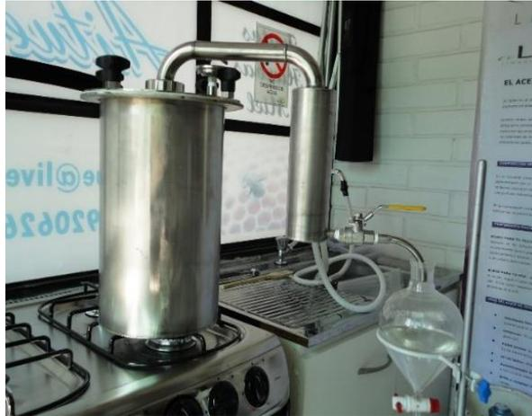
Figura 1. Destilador industrial para aceites esenciales modelo AE-10 [13]
