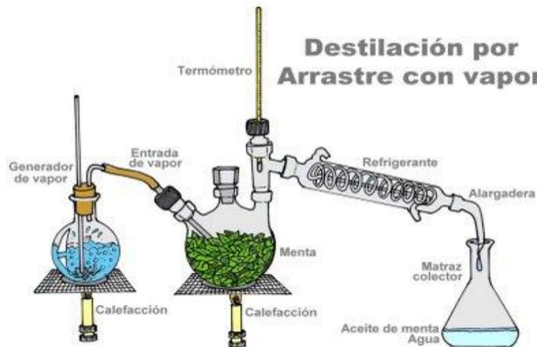
Figura 4. Proceso de destilación de esencia por arrastre de vapor [16]
