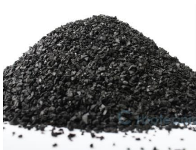
Figura 7. Carbón Activado Granular. [14]
