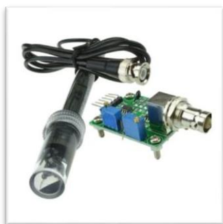
Figura 12. Sensor de pH. [22]
