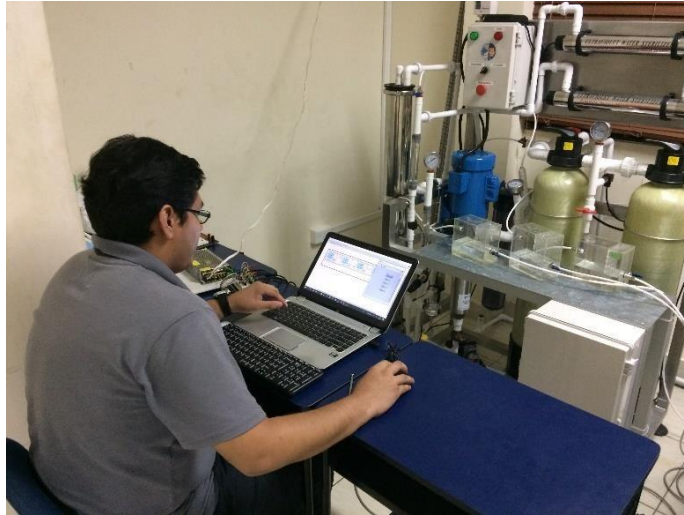
Figura 58. Prueba de los transductores de presión.
