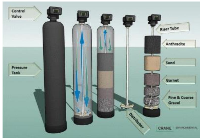
Figura 5. Diseño del tanque utilizado para medios filtrantes. [11]
