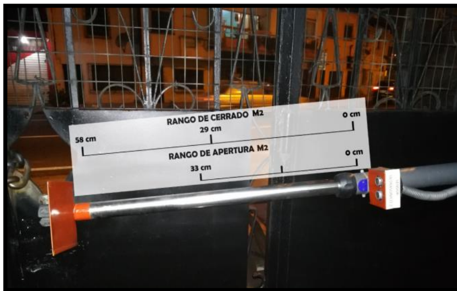
Figura 3.88: Desplazamiento del vástago del M2
