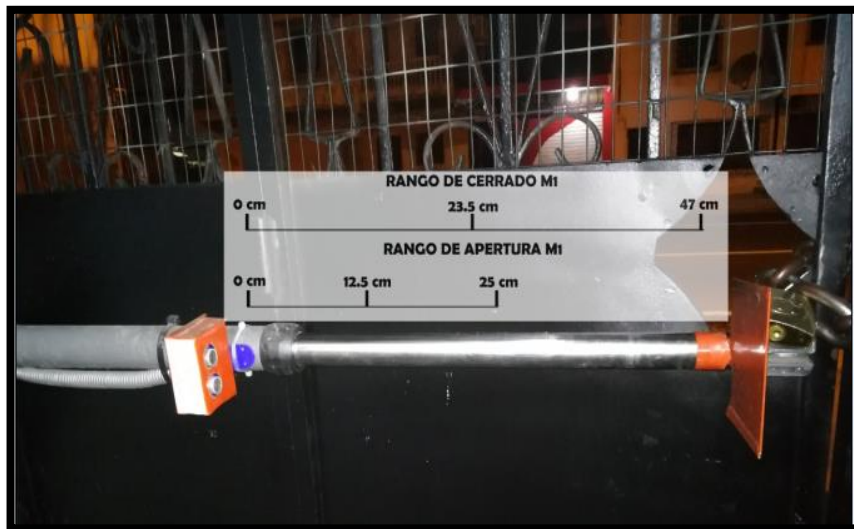
Figura 3.86: Desplazamiento del vástago del M1
