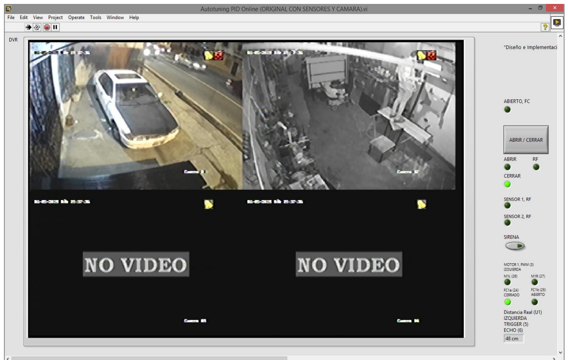
Figura 4.3: Panel frontal con los videos de las cámaras y las botonerías virtuales de accionamiento
