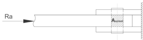
Figura 39. Carga en el eje pivote para esfuerzo por aplastamiento. Elaborado por: Galo Guañuna & Junior Ortiz
