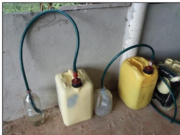
**Anexo 17.** Introducción del cebador en la primera carga del biodigestor.
