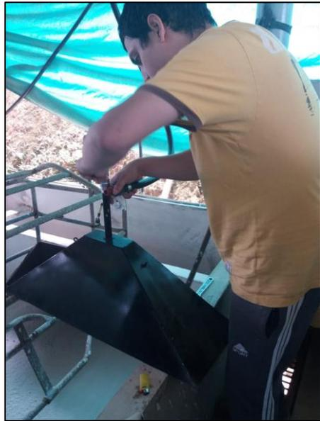
**Anexo 23.** Conexión de la manguera politubo al quemador.
