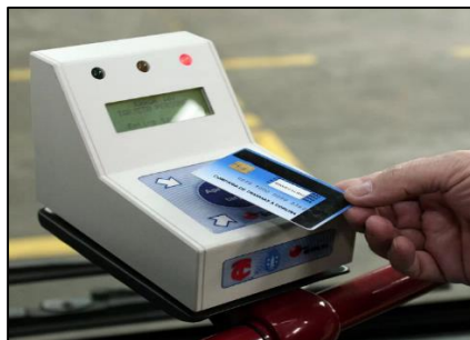
Figura 1.4: Transacción incorrecta de la tarjeta con microchip de contacto.
