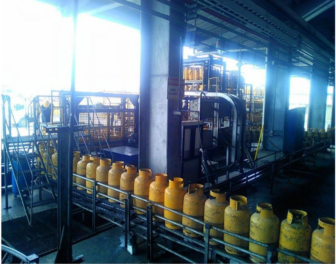
**Figura 28.** Línea de carga de ingreso de cilindros llenos a la paletizadora.
