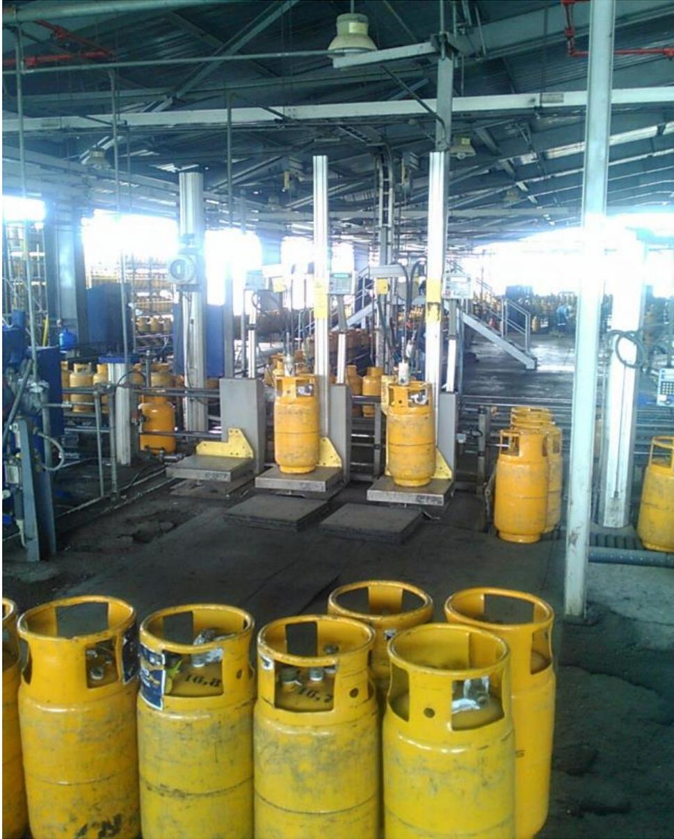
**Figura 26.** Llenado de Cilindros tipo Industrial de 16 Kg
