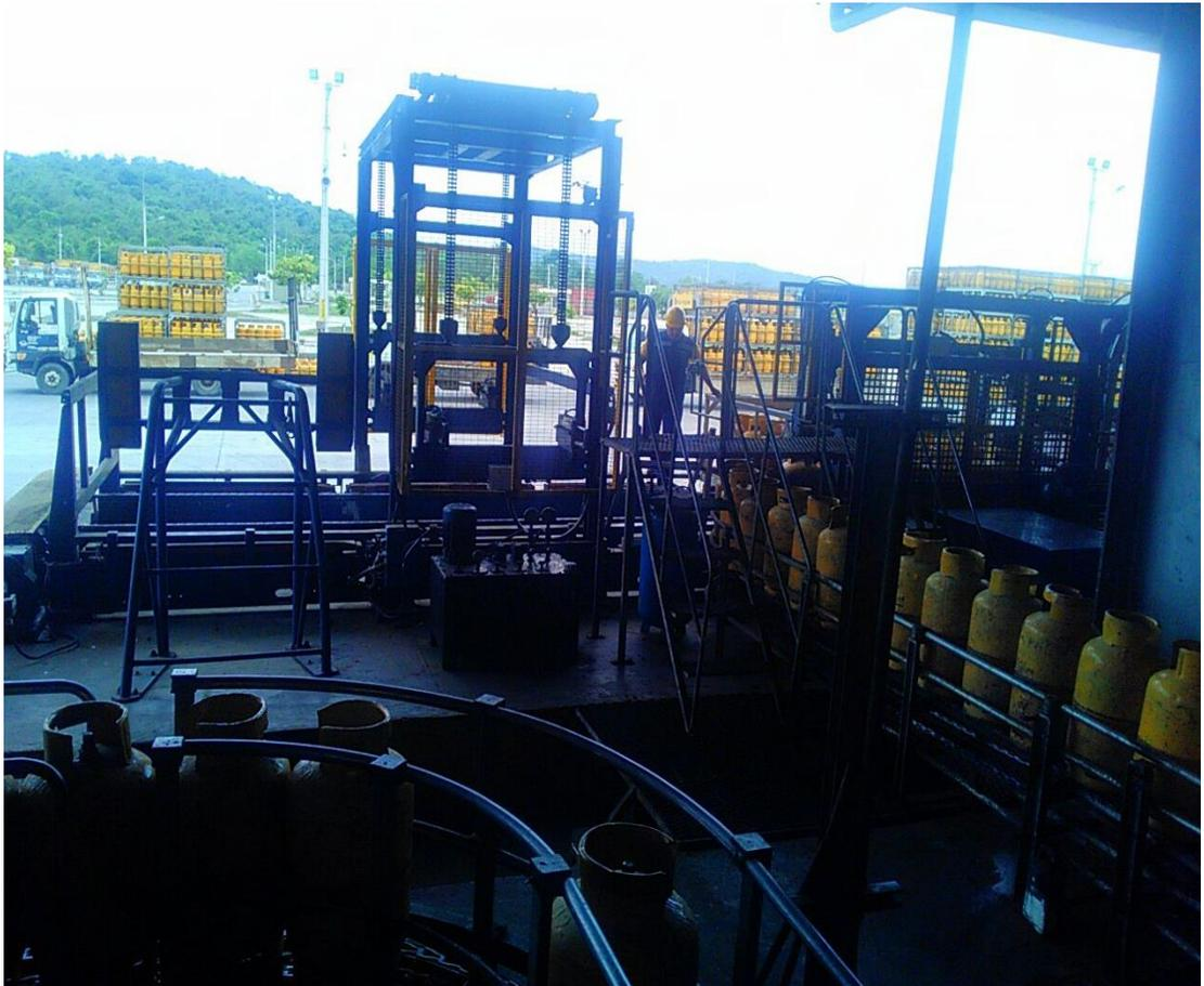
**Figura 27.** Paletizado de cilindros uso doméstico de 15 Kg
