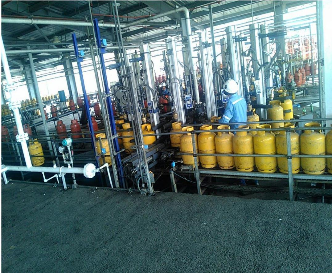
**Figura 30.** Línea de Ingreso de Cilindros tipo domésticos al carrusel #3
