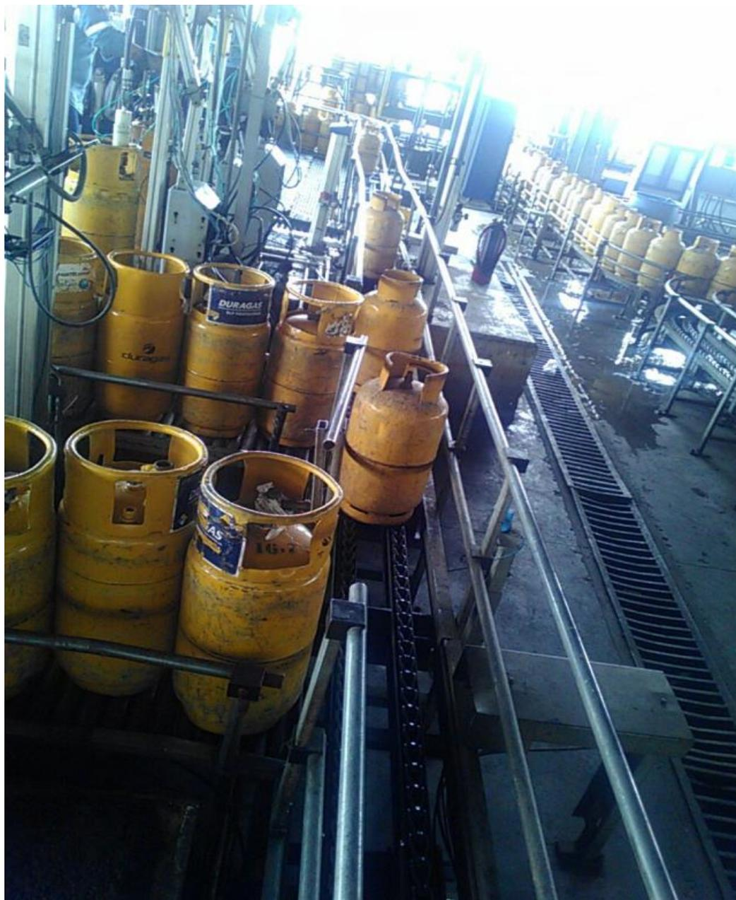
**Figura 29.** Línea de carga de cilindros industriales a los pallets.
