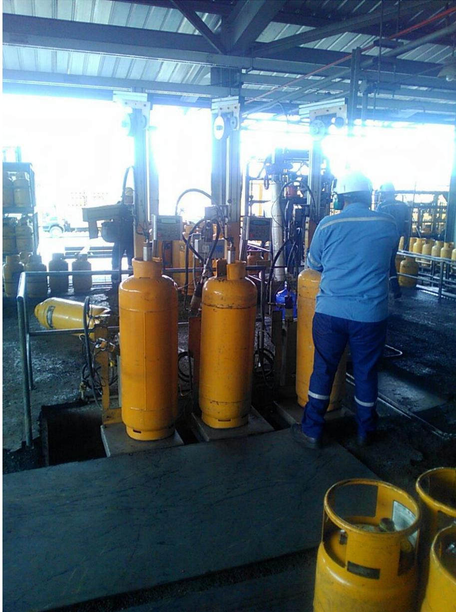
**Figura 25.** Llenado de Cilindros tipo Industrial de 45Kg.
