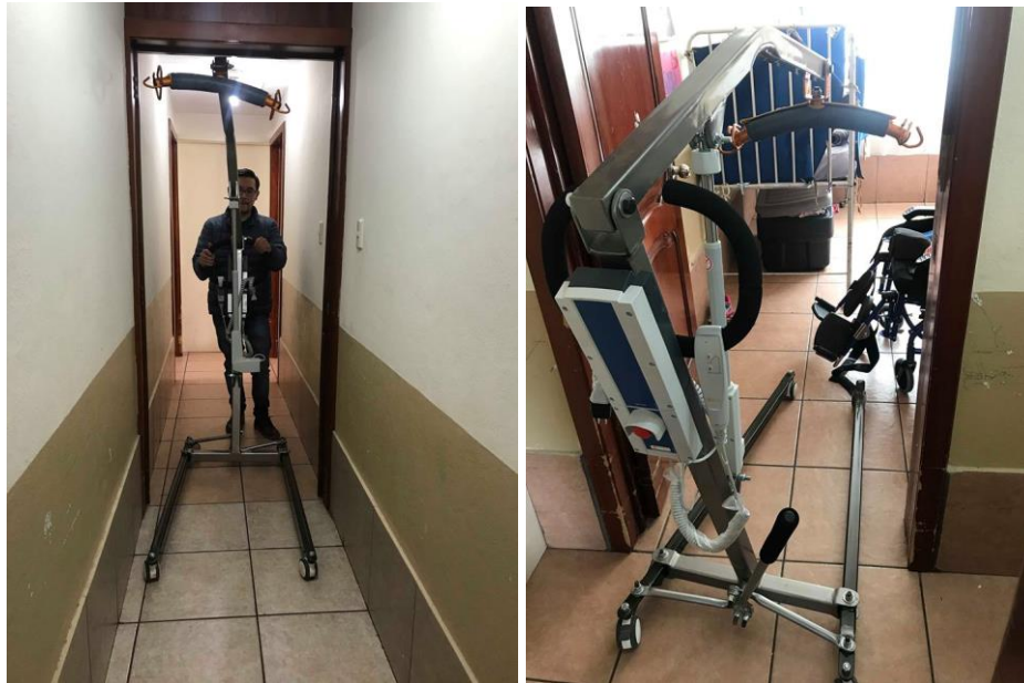
Figura 83: Pruebas finales en pasillos y puertas de la fundación.
