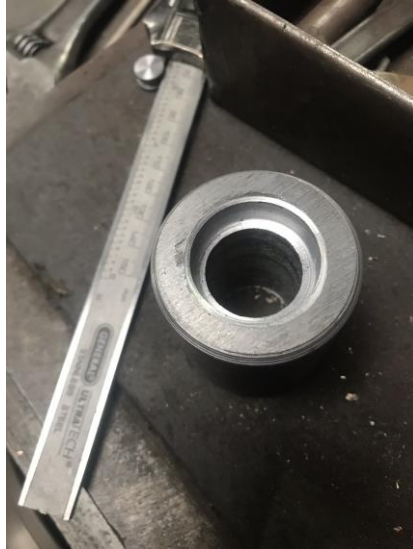
Figura 69: Mecanizado de bujes para el rodamiento
