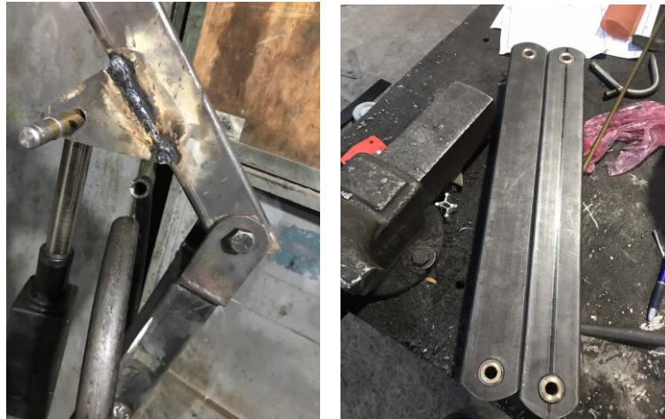
Figura 75: Proceso de soldadura soporte y bujes de bronce
