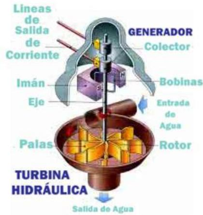
Figura 10. Esquema de una turbina hidráulica [26]
