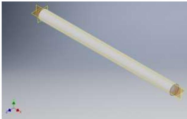
Figura 40. Eje principal de la turbina
