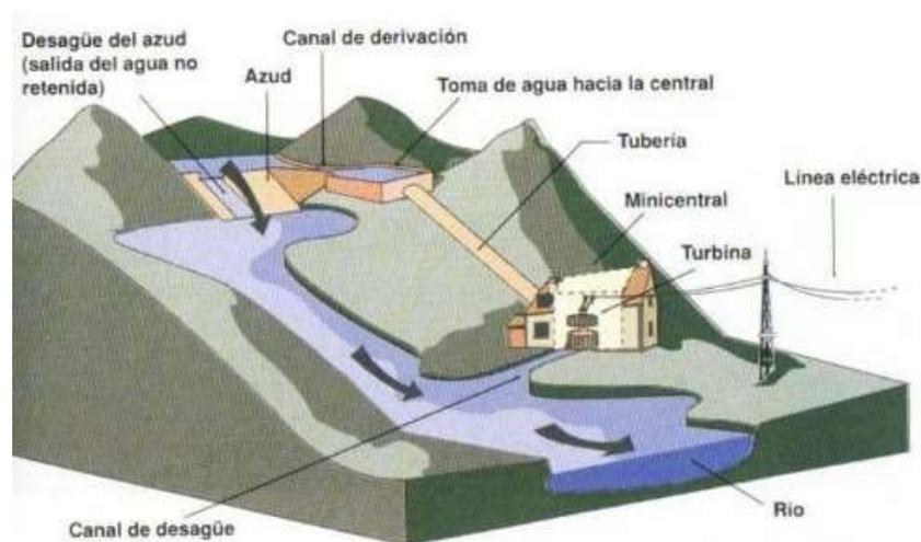
Figura 1. Componentes de una central de agua fluyente [5]
