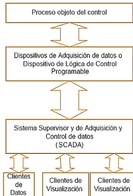
Figura 1.1 *Arquitectura de un Sistema SCADA.*
