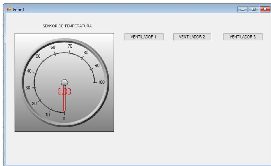
Figura 3.20. Sistema SCADA de control de temperatura en Visual Studio 2012.
