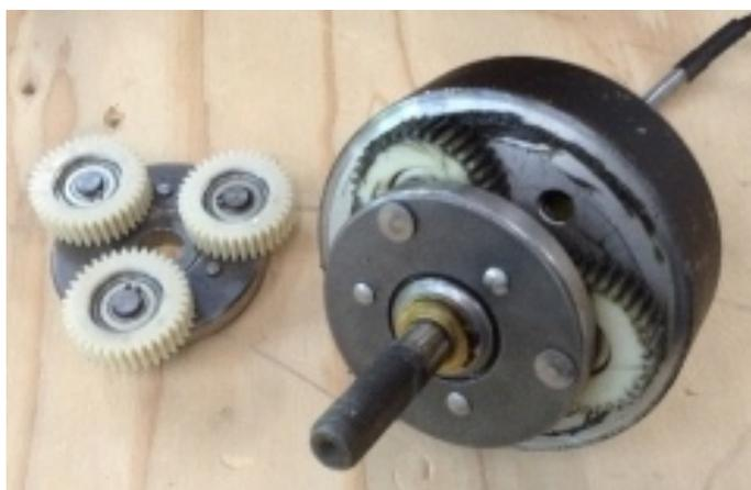
*Figura 8: Motor DC sin escobillas con piñones o engranajes. [14]*
