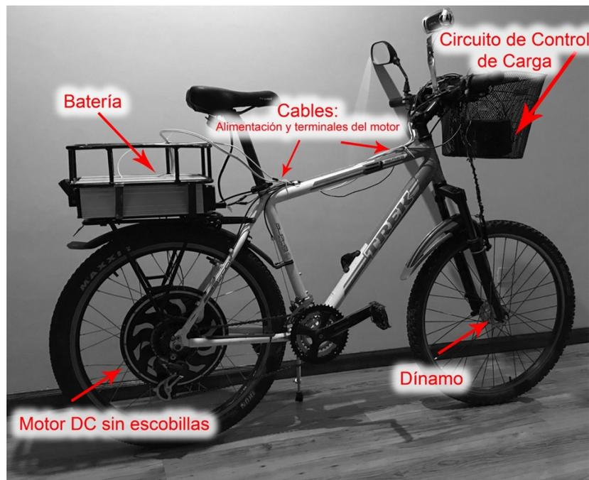
Figura 18: Ubicación de partes que conforman el sistema de control de carga.
