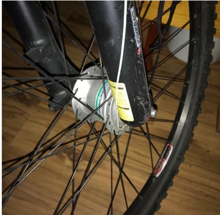
Figura 56: Dínamo acoplado al eje de la llanta delantera de la bicicleta.
