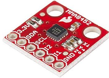
*Figura 43: Acelerómetro.*
