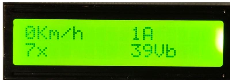
Figura 47: Información que se visualiza en la pantalla LCD.
