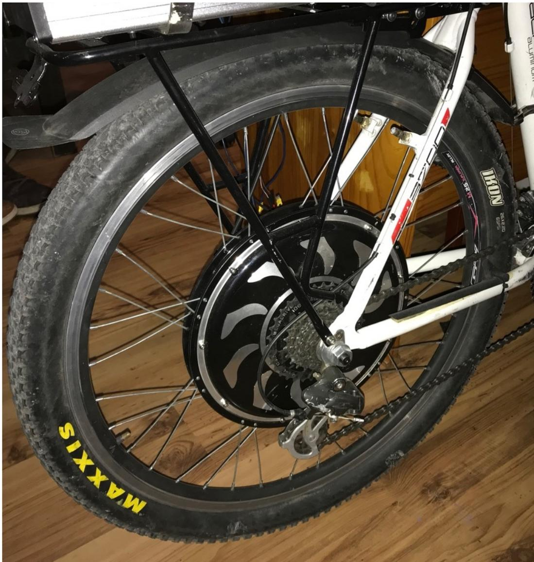
*Figura 58: Motor DC sin escobillas en la bicicleta.*
