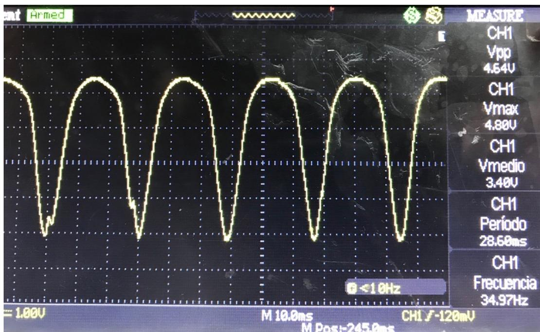
Figura 66: Señal proveniente del dínamo en el convertidor ADC.
