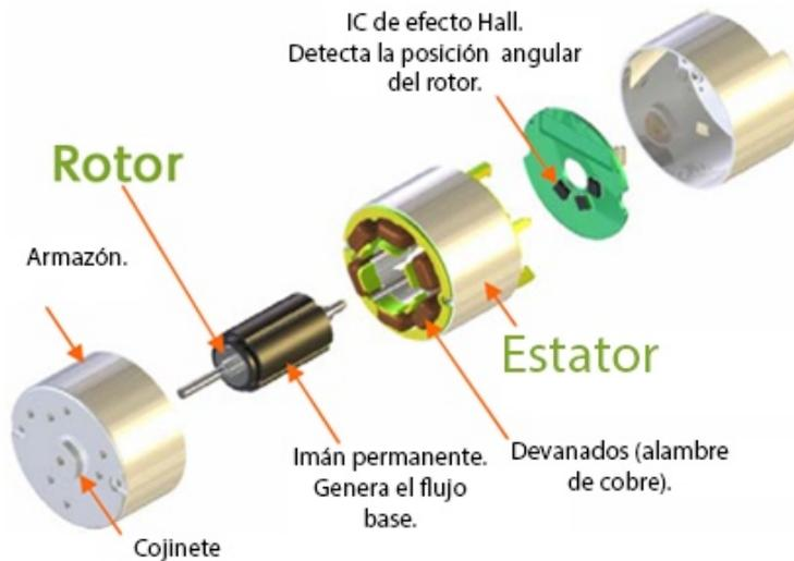
Figura 10: Motor sin escobillas con rotor interno. Figura traducida por el autor. [9]
