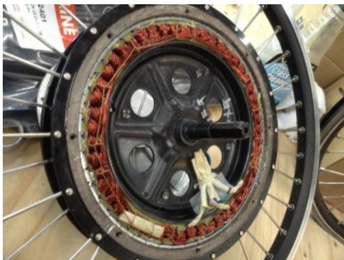
*Figura 7: Motor DC sin escobillas de accionamiento directo. [14]*
