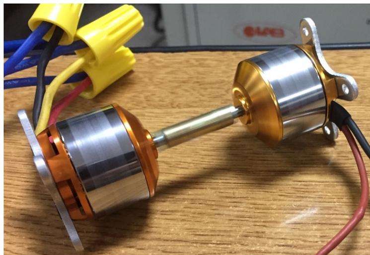
*Figura 29: Motor y generador acoplados a través de su eje.*
