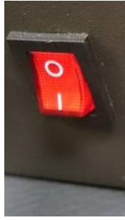
Figura 27- Interruptor encendido y apagado
