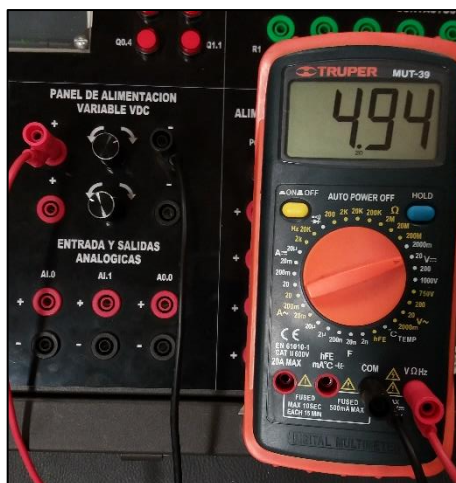
Figura 29- Medición de la fuente variable
