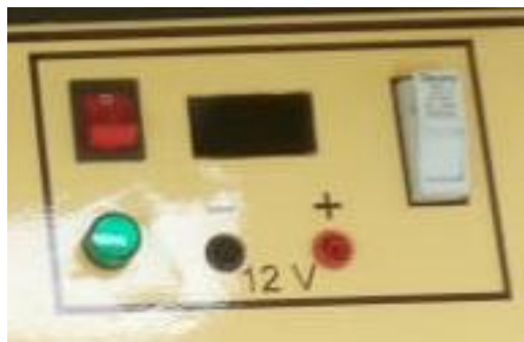
FIGURA 3. 21: FUENTE DE VOLTAJE DE +/- 12VDC.
