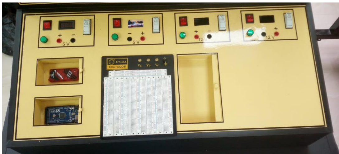
FIGURA 3. 9: MONTAJE DE EQUIPOS Y MATERIALES EN MÓDULO DE PRUEBAS DE CIRCUITOS ELÉCTRICOS – VISTA INFERIOR.
