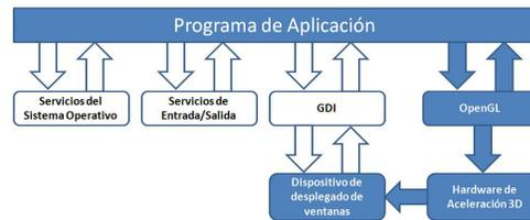
FIGURA 3.2.1. Aplicación utilizando OpenGL y aceleración gráfica por hardware. [49]
