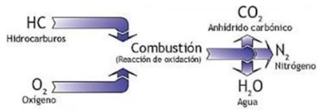
Figura 4.6.1. Proceso de combustión
