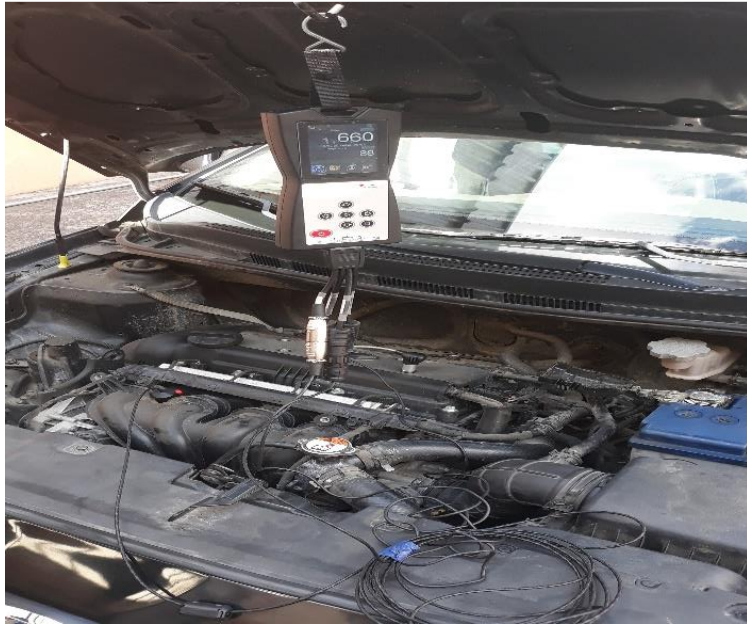
Figura 9.7.2.13. Instalación de los equipos de medición de RPM
