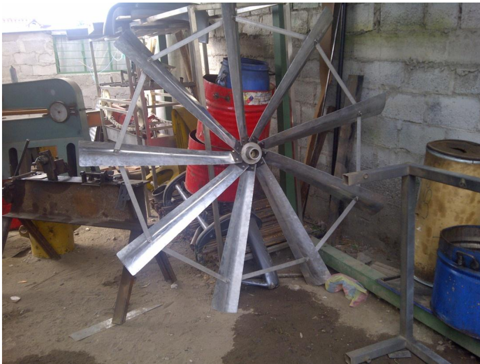
Figura 4.22 Montaje de las aspas.
