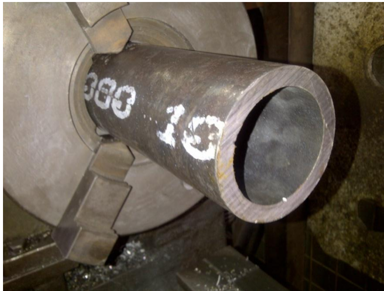
Figura 4.12 Sujeción del eje perforado.
