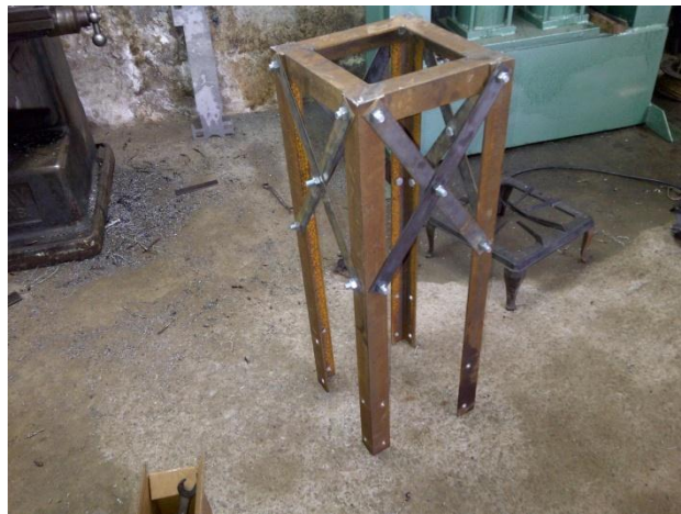
Figura 4.7 Ensamble del tramo porta aspas.
