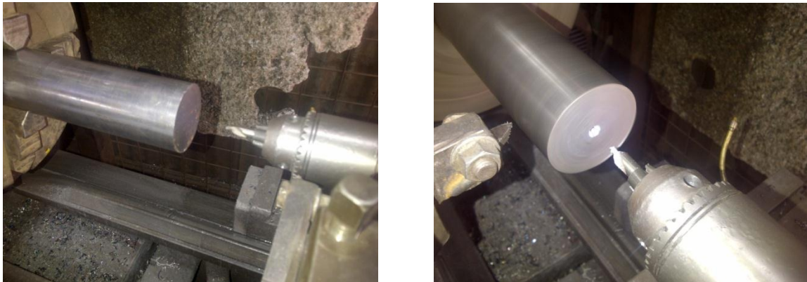
Figura 4.9 Perforación Broca de centros.
