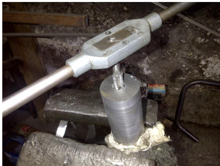
Figura 4.11 Perforación y roscado.
