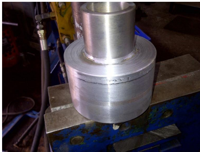
Figura 4.15 Mecanizado de porta aspas.
