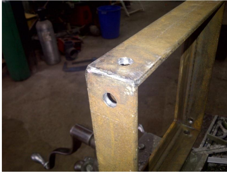
Figura 4.3 Cuadro de montaje soldado mediante un proceso MIG.
