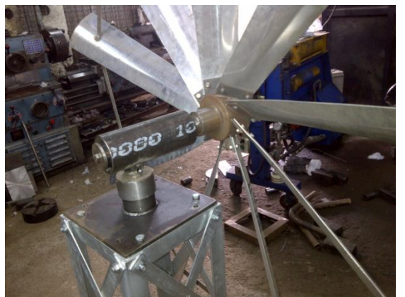
Figura 4.31 Soldadura de porta carbones con porta aspas.
