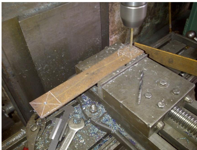
Figura 4.2 Perforaciones para el cuadro de montaje del sistema porta aspas.
