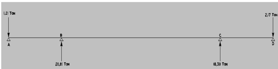
**Fig.2.21** Reacciones en tubería.
