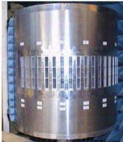
**Figura 28.** Array cilíndrico de bocinas rectangulares
