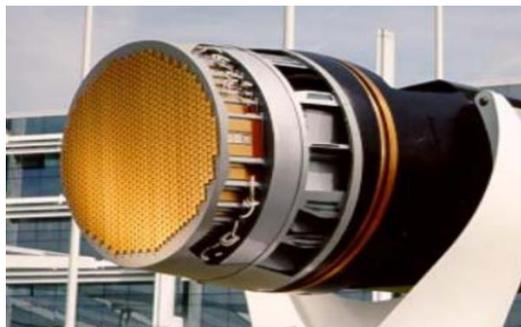
**Figura 27.** Antena adaptativa para un sistema radar a bordo de un avión
