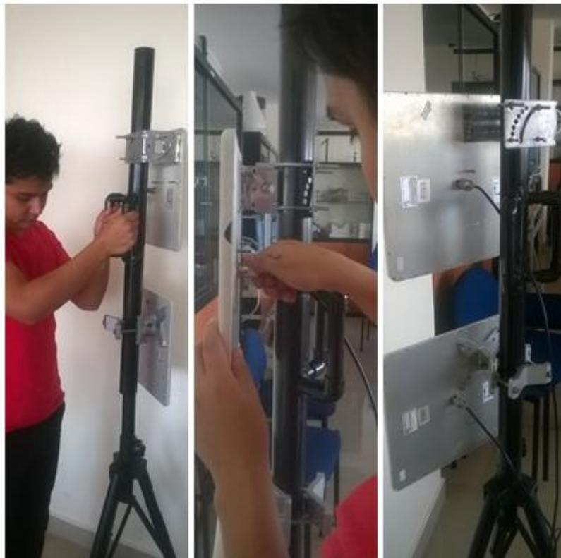
**Figura 44.** Montaje de la base móvil sobre el trípode y conexión de antenas.
