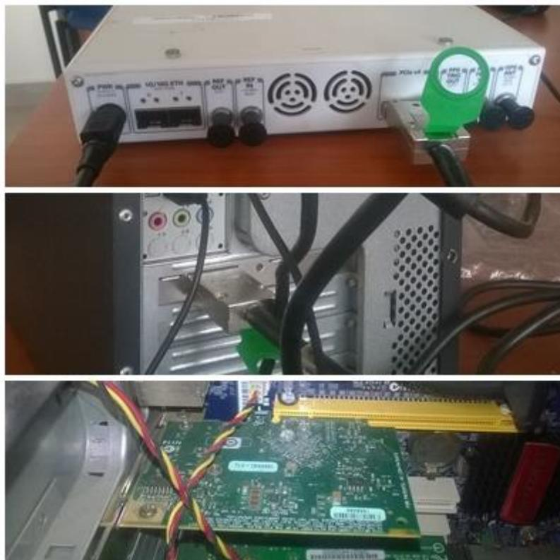
**Figura 46.** Conexión del dispositivo USRP RIO 2943 al computador
