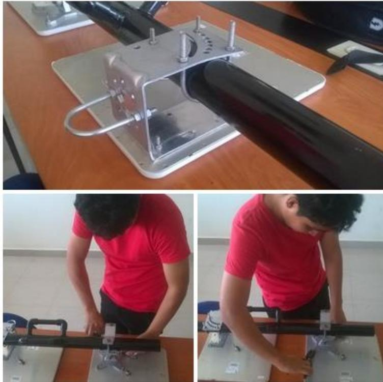
**Figura 43.** Montaje de los paneles sobre una base móvil
