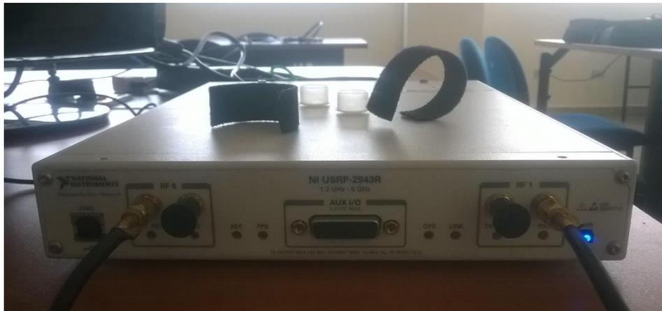
**Figura 45.** Conexión al dispositivo USRP RIO 2943
