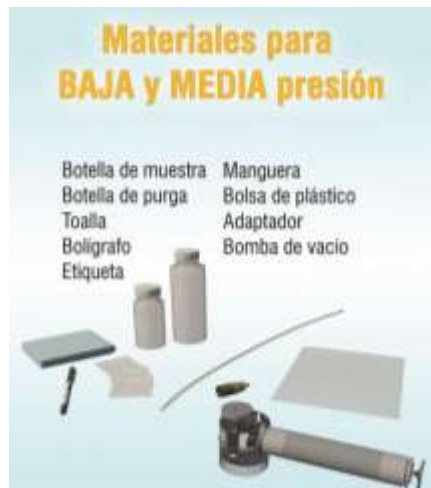
Figura 40 Materiales para la toma de la muestra de aceite [62]
