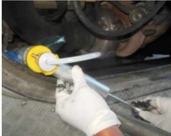
Figura 57 Extracción de aceite desde el cárter [Autores]
