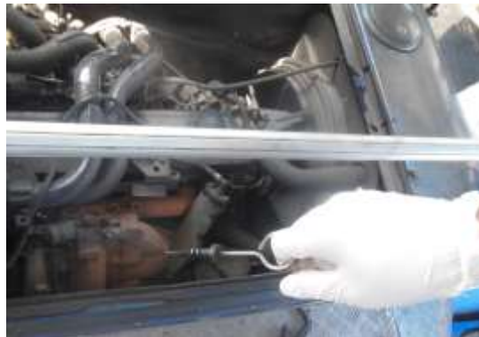
Figura 52 Retirar la varilla de medición del aceite de motor [Autores]
