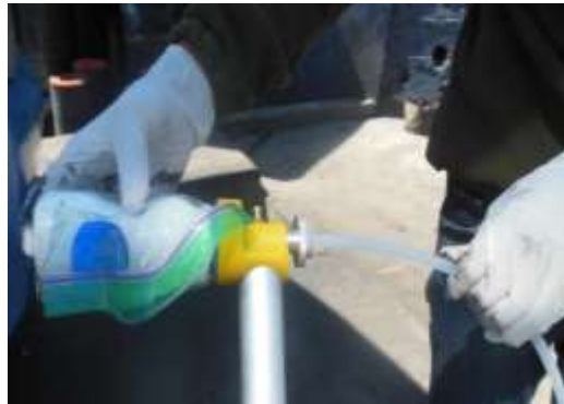
Figura 55 Introducir manguera de muestreo [Autores]
