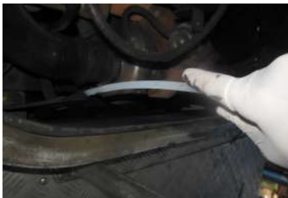
Figura 56 Insertar la manguera por el tubo de la varilla [Autores]
