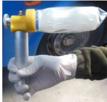
Figura 51 Ajustar en envase en la bomba de extracción [Autores]
