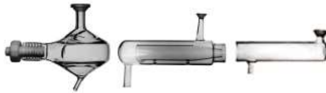
Figura 27 Cámara de nebulización ciclónica (izq.), tipo concéntrica de paso doble (centro) y tipo concéntrica de paso simple (der.)
