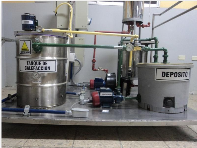
*Figura 5.4 Módulo de control de temperatura Fuente: Autores*
