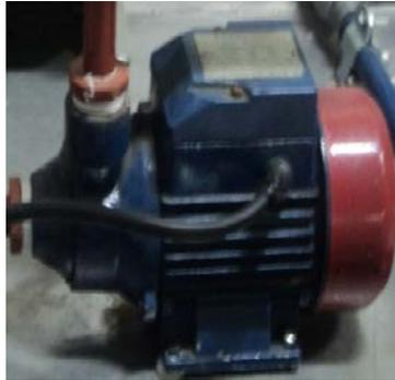
Figura 2.5 Bomba de succión PEDROLLO Fuente: Autores
