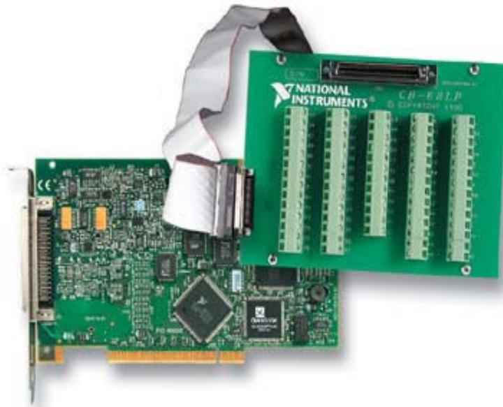
Figura 2.23 Tarjeta de adquisición de datos Fuente: Autores
