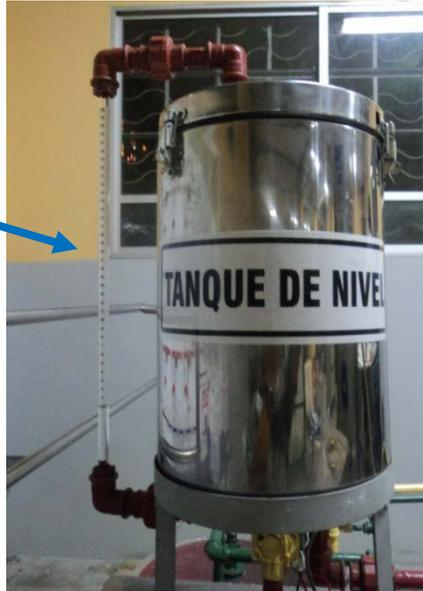
Figura 2.8 Tubo indicador de nivel con graduación Fuente: Autores
