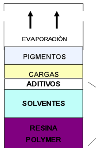
Fig. 5 Componentes de tinta base solvente.
