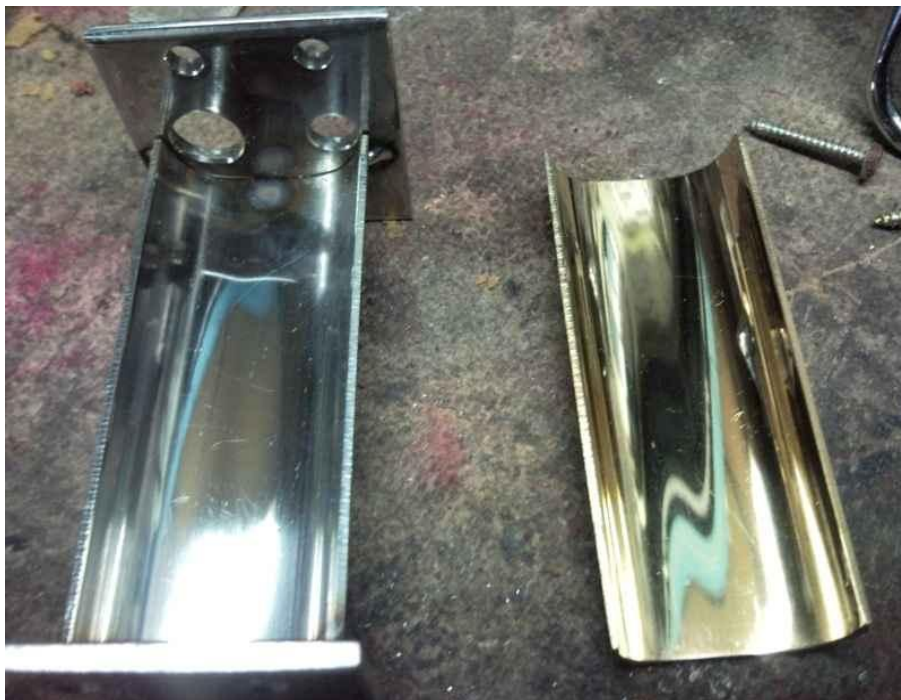
Fig. 16 Reflector de aluminio-titanio
