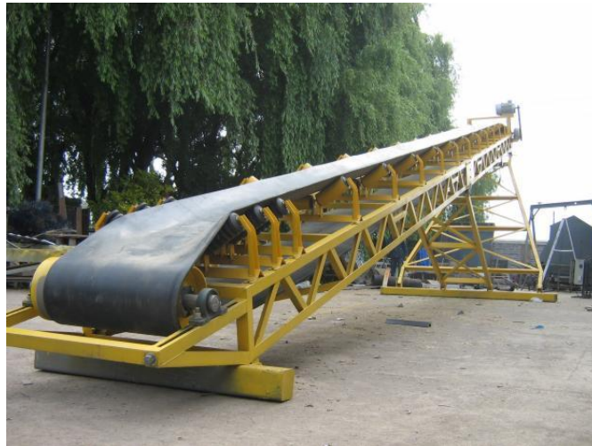
Fig. 18 Banda transportadora de caucho
