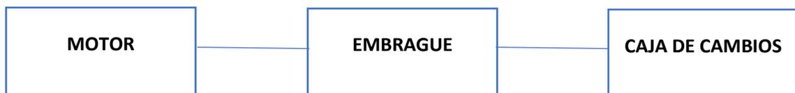
*Figura 20: Distribución del conjunto de embrague en el vehículo*
