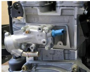
*Figura 13: Ubicación del sensor ECT.*
