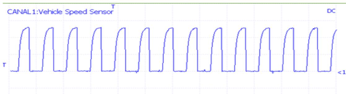
Figura 18: Comportamiento que genera la lectura del sensor VSS.
