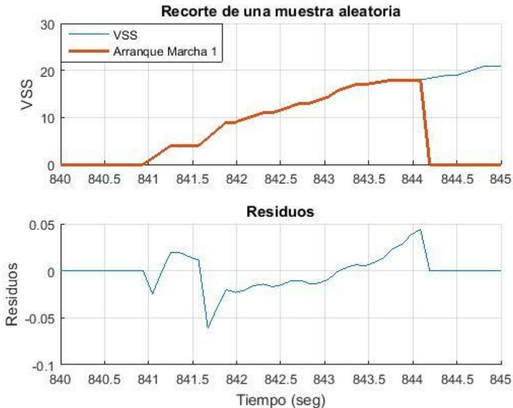
Figura 51: Comportamiento real de residuos en arranque del vehículo.
