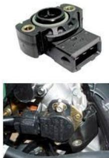
Figura 7: Ubicación del sensor TPS.
