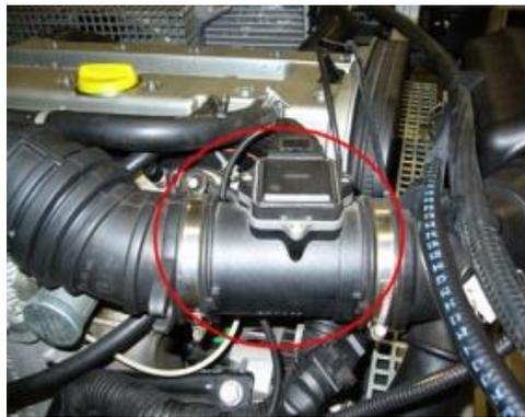
Figura 5: Ubicación del sensor MAF.
