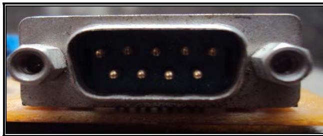
Figura 1.1 Conector serial RS-232
