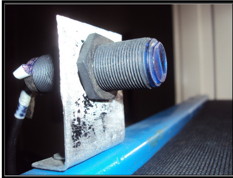
Figura 3.23 Sensor detector capacitivo
