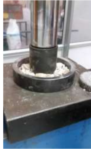
Ilustración 18 Trituración de rocas en la prensa
