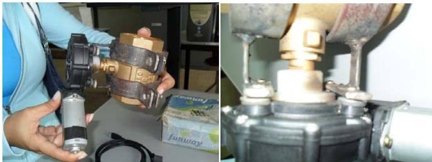
Motores eléctricos elevadores vidrios se utilizaron para automatizar la distribución del alimento con válvulas de bola y un diseño de un engranaje entre la válvula y el motor.
