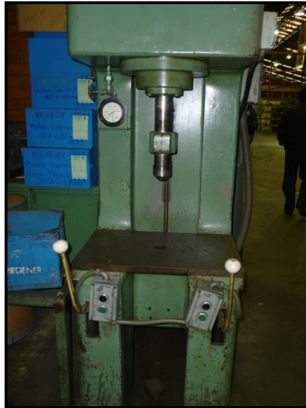
Ilustración 106 “Prensa hidráulica 15 toneladas Denison propiedad de FV Área Andina” 213
