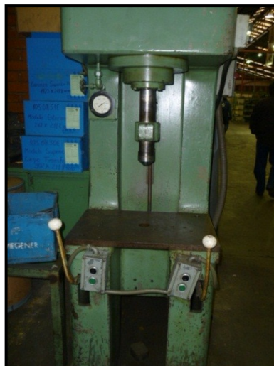
Ilustración 109 “Prensa hidráulica 15 toneladas Denison propiedad de FV Área Andina” 217
