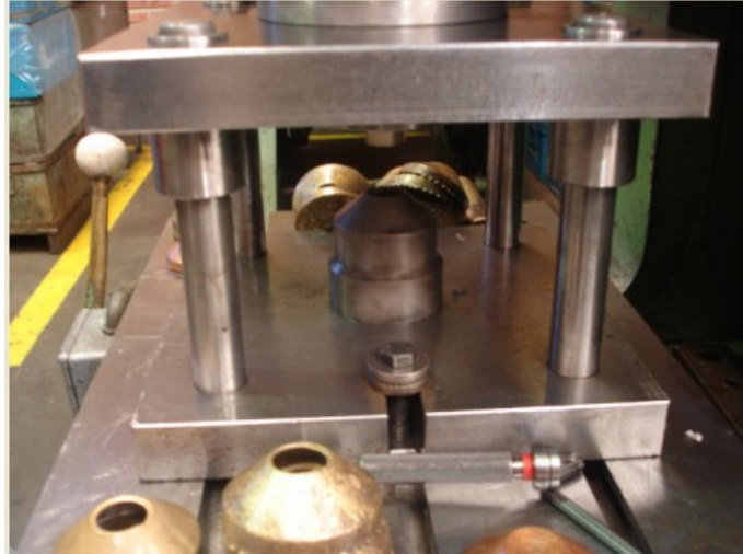
Ilustración 14 Corte y conformado de hélice 40
