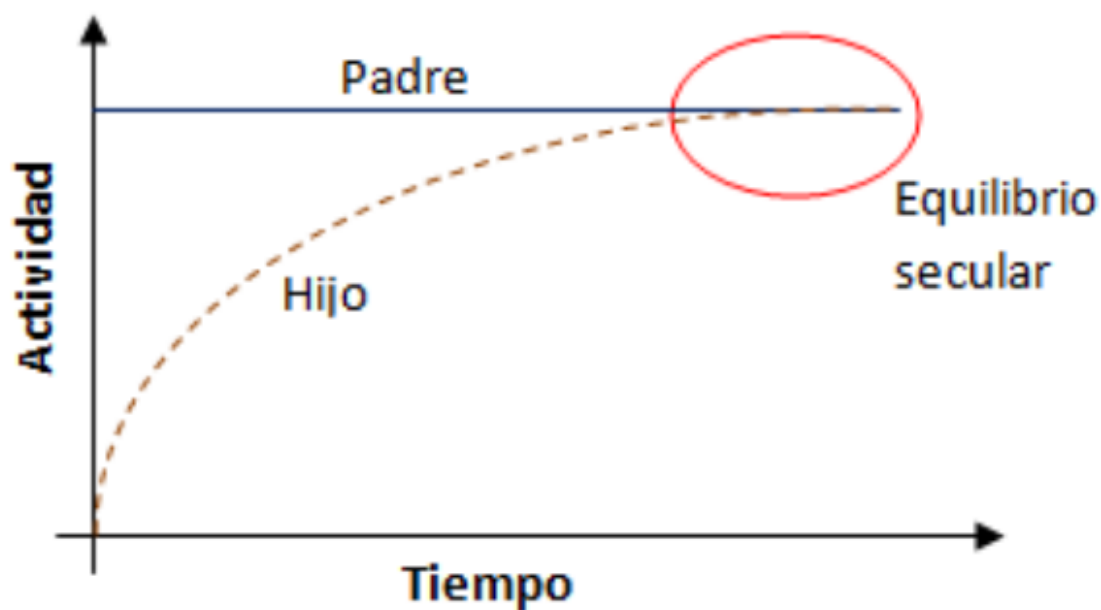
Figura 5 Gráfico de equilibrio secular de un radioisótopo Fuente: (Determinacion de aerosoles radiactivos con muestreadores de bajo caudal)
