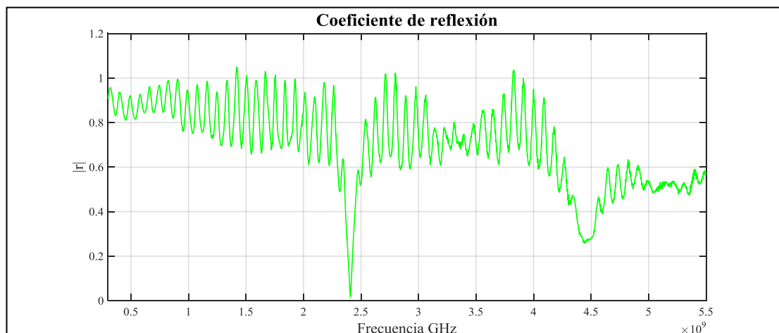
Figura 4.38 Coeficiente de reflexión de la antena planar circular. Fuente: Autora
