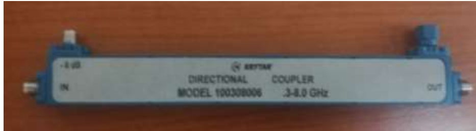
Figura B.3 Directional Coupler Laboratorio de Telecomunicaciones UPS.
