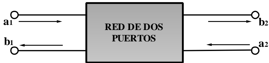
Figura 1.6 Esquema de la red de dos puertos Fuente:[14]
