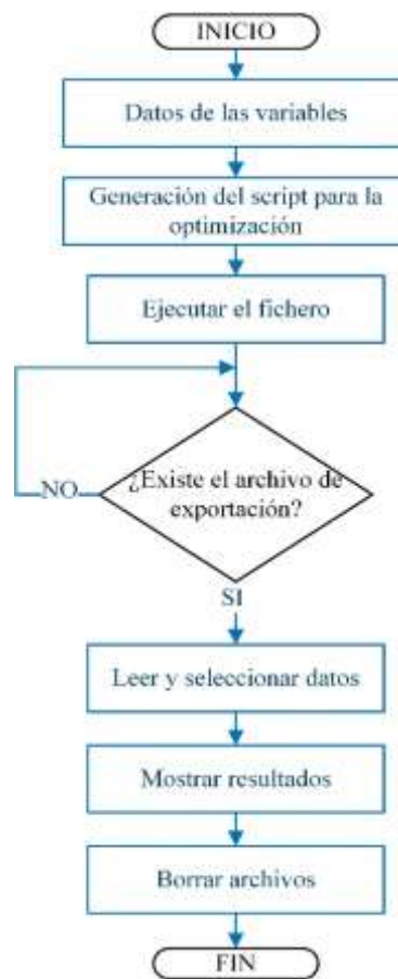
Figura 3.6 Diagrama de flujo del proceso de evaluación mediante la comunicación Fuente: Autora
