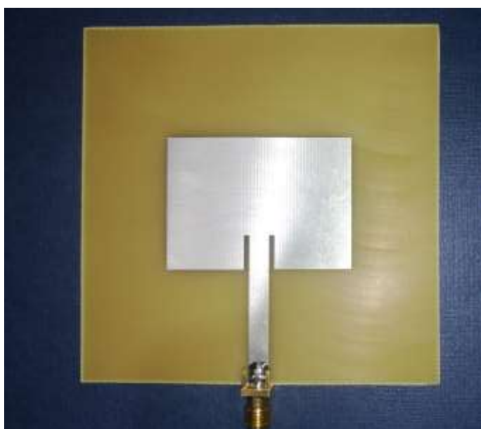
Figura 4.30 Antena planar rectangular construida.
