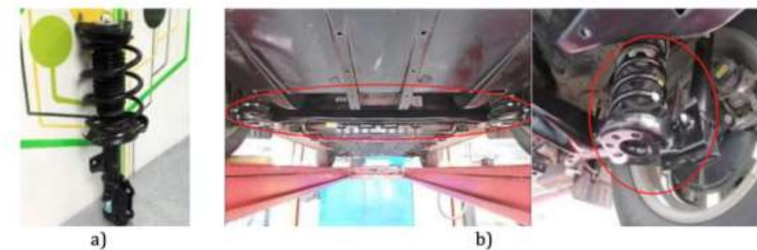
Ilustración 7: Sistemas de seguridad de la suspensión a) suspensión delantera, b) suspensión posterior.
