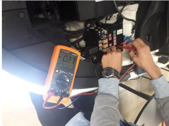
Figura 252: Proceso de validación de Datos (Consumo de corriente Audio)
