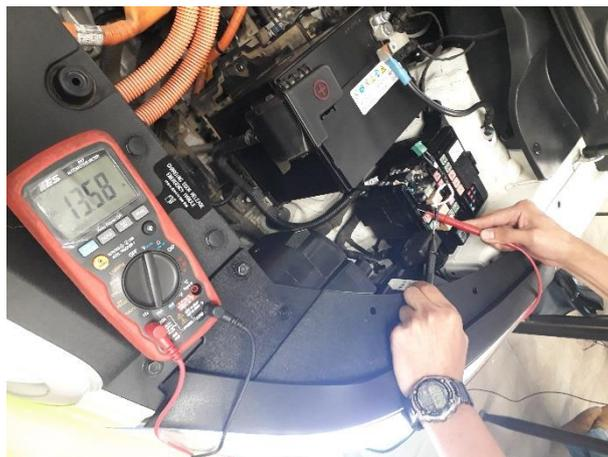
Figura 33: Proceso de validación de Datos (Consumo de corriente Calefacción)
