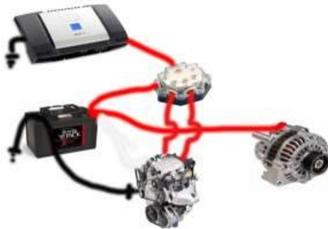
Figura 13: Conexión del sistema de audio
