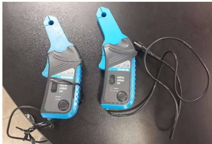
Figura29: Pinzas Amperimétricas
