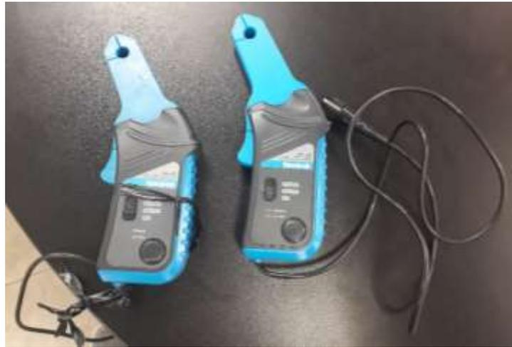
Figura29: Pinzas Amperimétricas
