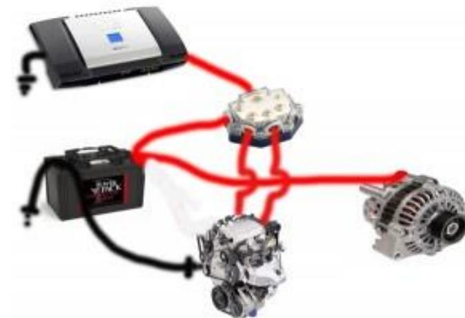
Figura 13: Conexión del sistema de audio
