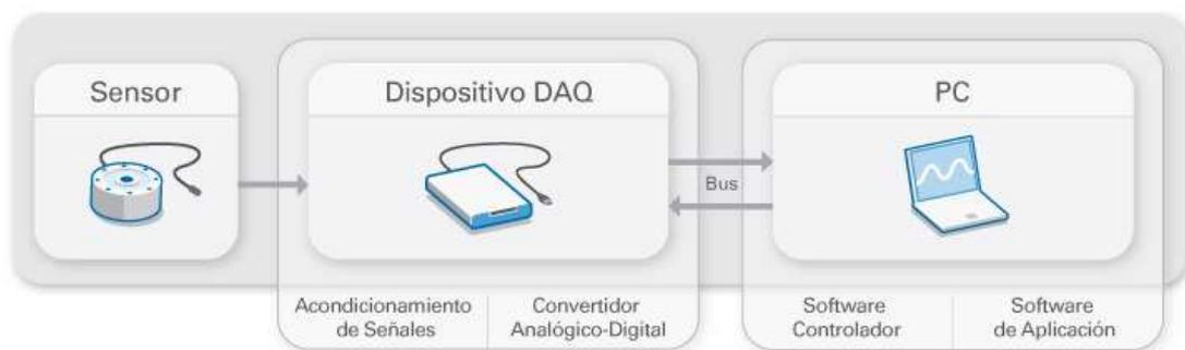
Figura 28: Proceso de Adquisición de datos con la DAQ
