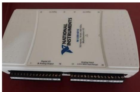
Figura 27: Tarjeta de Adquisición de Datos
