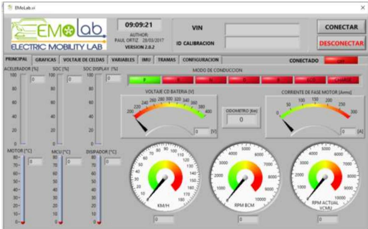
como: temperatura del motor, estado de carga, voltaje de las celdas, posición del acelerador, consumo energético, etc.,
