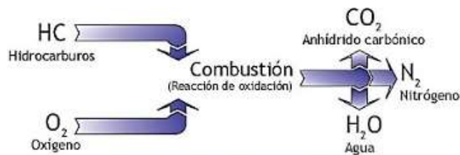
Figura 4.2 Proceso de combustión.
