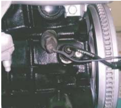
Figura 6.13 Sensor de RPM
