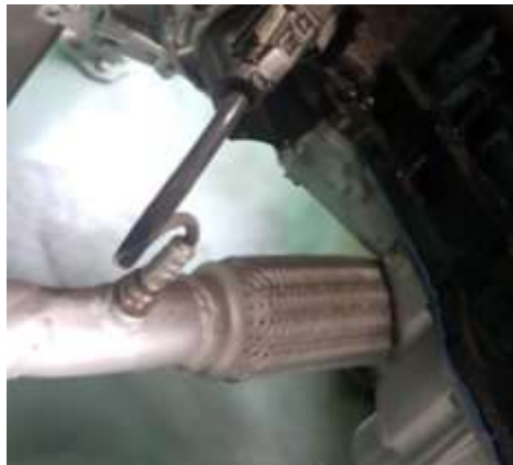
Figura 6.14 Sensor de Oxígeno (O2)
