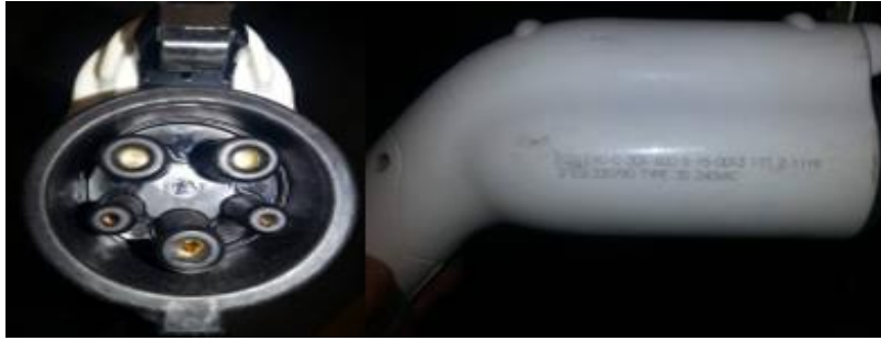
Figura 11. Conector de la estación de carga modo 2 instalado en el laboratorio de movilidad eléctrica.
