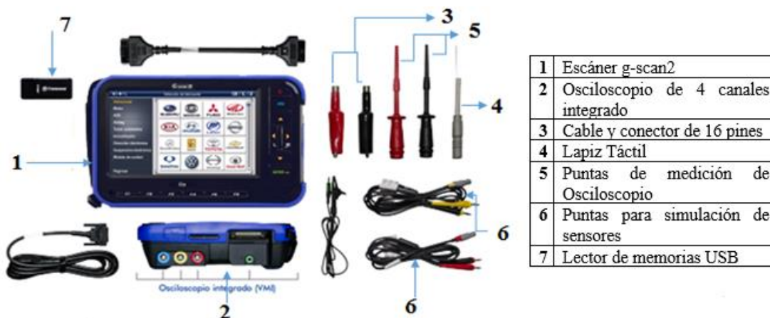
Figura 1. Partes y elementos del escáner G-scan2.
