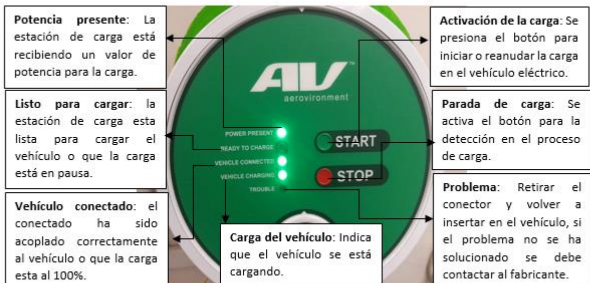
Figura 8. Indicadores principales de la estación de carga.
