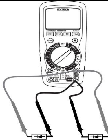
Figura 4. Visualización de la forma de medición en escala de continuidad y prueba de diodos mediante el Multímetro Automotriz.
