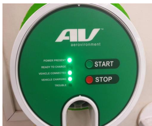
Figura 1. Estación para carga de acumuladores de alto voltaje Aerovironment para V.E.
