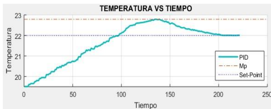
Figura 4.1 Curva de comportamiento del controlador PID en la planta de temperatura con set point ( 22^{\circ}\text{C} ) con respecto al tiempo
