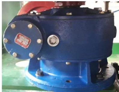
Caja reductora con tornillo sin fin utilizada para el movimiento de la etiquetadora Elaborado por:
