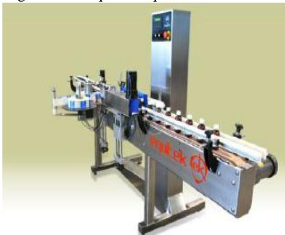
Modelo de una máquina etiquetadora. Fuente: <http://equitek.com.mx/equipos/SerieES1/28.php>
