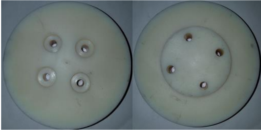
Figura 4.1 Expansor de la polea del cigüeñal terminada. (Autores)
