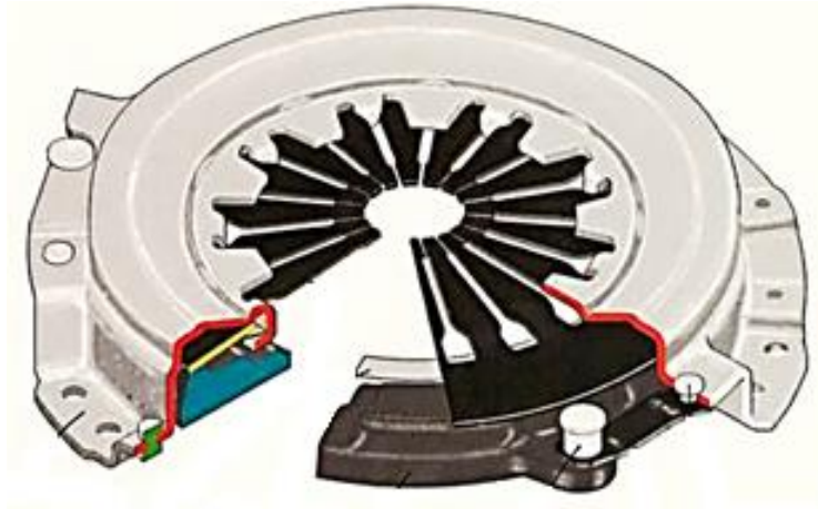
Figura 2.1 Partes del Disco de Embrague (FERRER, 2016)
