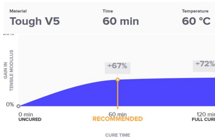
Figura 113. Curva representativa para el curado de la resina Tough [55].
