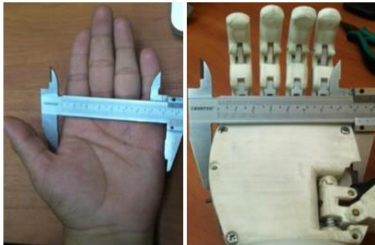
Figura 1. Mano real vs prótesis biomecánica Maki 2.0 [5].
