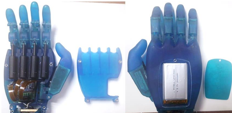
Figura 120. Ensamble de elementos electrónicos y mecánica de la prótesis Maki 3.0
