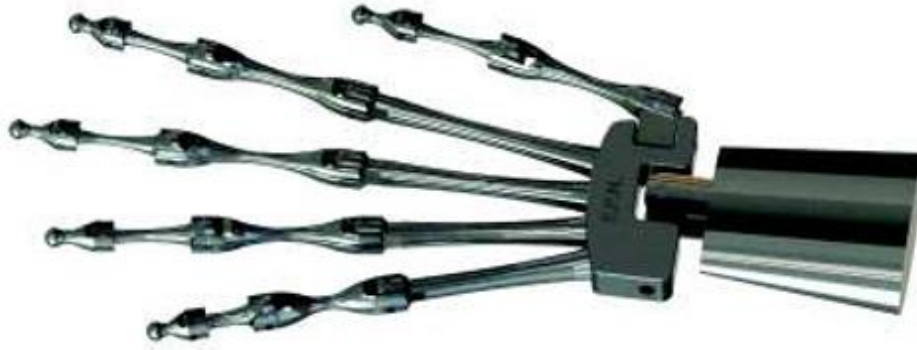
Figura 27. Diseño de 4 dedos con el carpo y el metacarpo [33].
