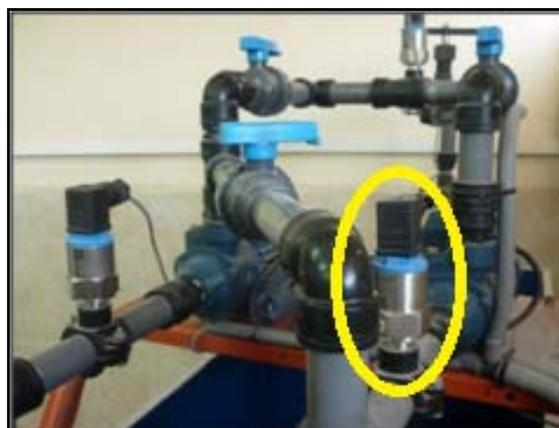
Figura 4.6: Sensor de presión negativa para la bomba 2.
