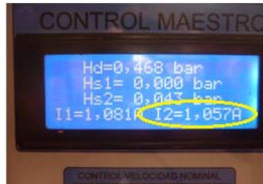
b) Adquisición de datos, pantalla de visualización.
