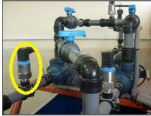
Figura 4.5: Sensor de presión negativa para la bomba 1.
