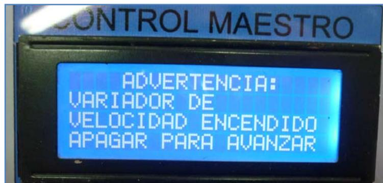
**Figura 3.11: Advertencia de Switch Encendido.**
