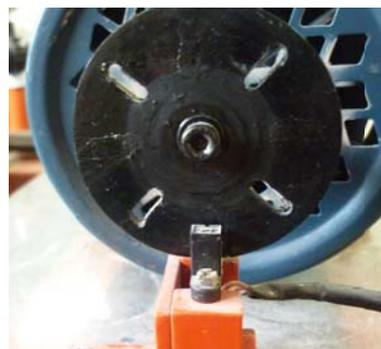
Figura 3.22: Disco Giratorio del Tacómetro.
