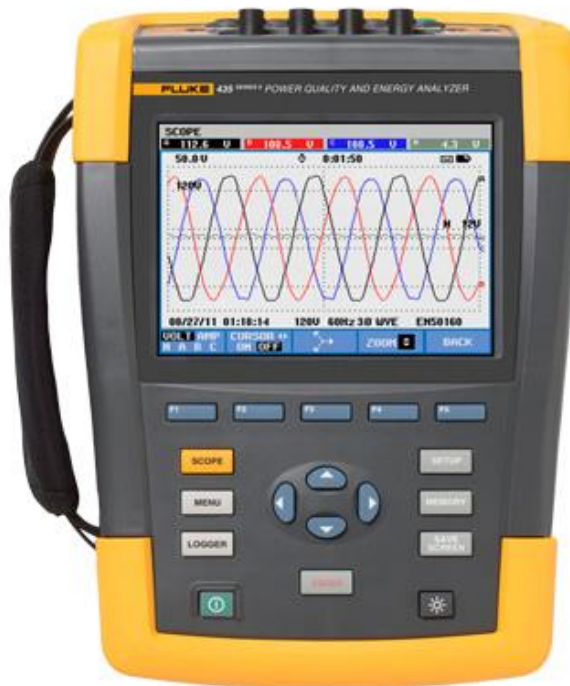
FIGURA 13: CARACTERÍSTICAS PRINCIPALES DEL ANALIZADOR DE REDES [28].
