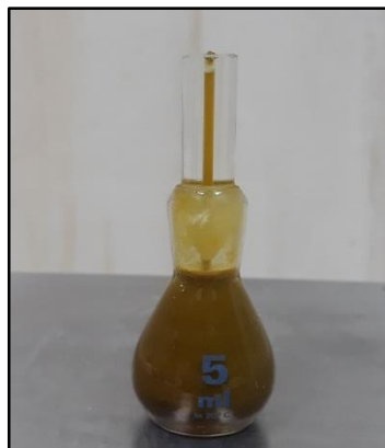
Figura 20: Medición de la densidad por el método del picnómetro
