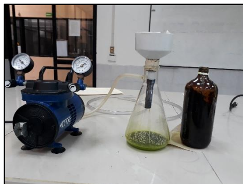
Figura 18: Filtración del macerado en la bomba de vacío Millipore Fuente: Autor
