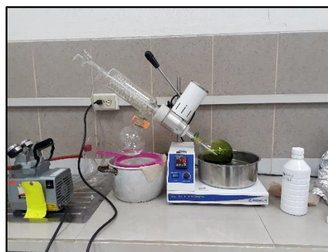
Figura 19: Recuperación del solvente en el rotavapor Fuente: Autor
