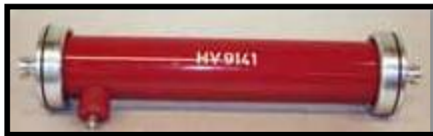
FIGURA 8: CAPACITOR DE MEDICIÓN
