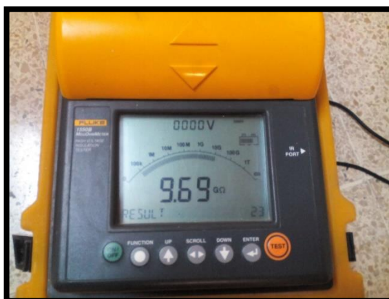
FIGURA 46: DATO DE RESISTENCIA DE AISLAMIENTO DEL INTERRUPTOR DE MEDIA TENSIÓN (CONTACTO-TANQUE / SWITCH CERRADO)
