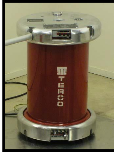
FIGURA 3: TRANSFORMADOR DE PRUEBAS [1]
