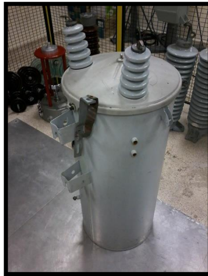
FIGURA 54: TRANSFORMADOR 50KVA – 7960V/240V
