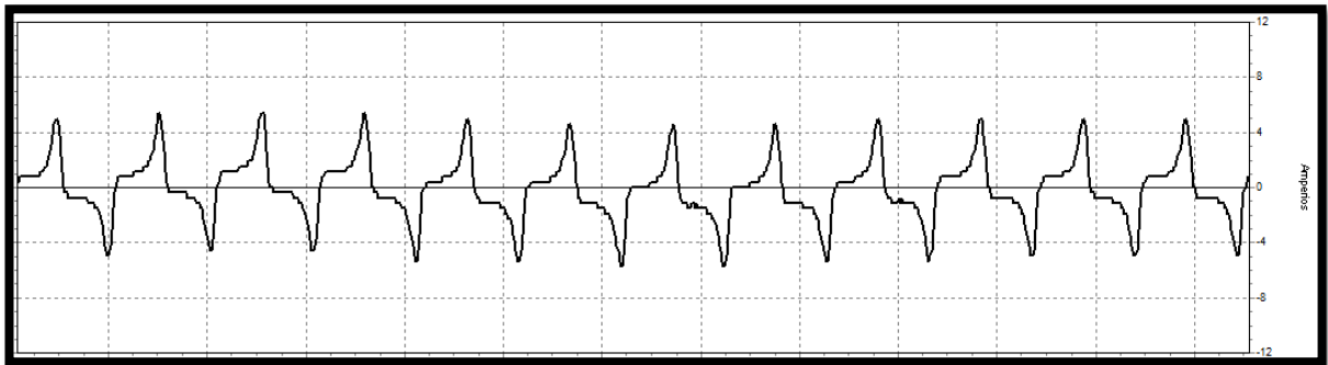
FIGURA 73: GRÁFICA EXPERIMENTAL DE LA CORRIENTE DE VACÍO EN EL TRANSFORMADOR
