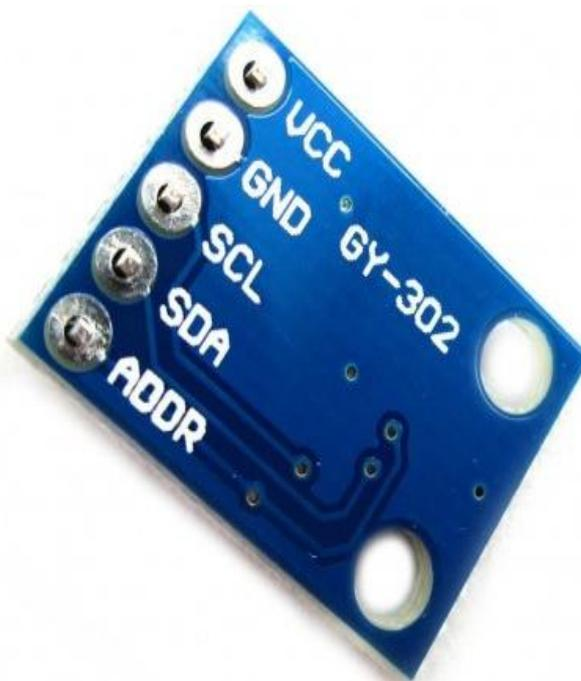
**Figura 13. Pines de conexión de sensor BH1750 (Naylamp Mechatronics)**
