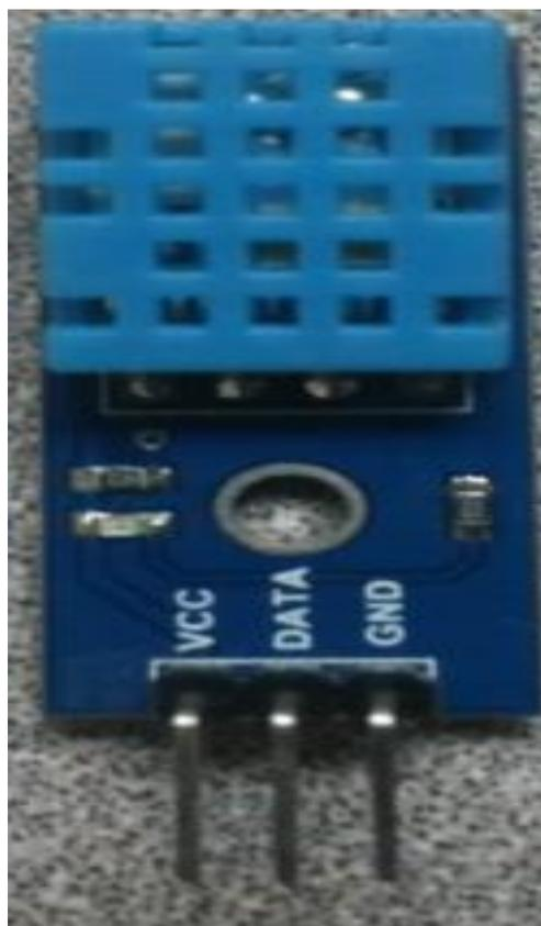
**Figura 16. Sensor Módulo DHT11(Los autores)**
