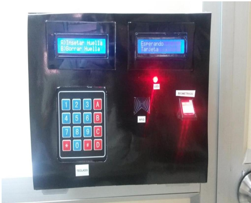
Figura 91. Instalación del panel frontal en la puerta de acceso(Los autores)
