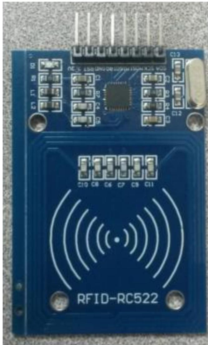
**Figura 26. Lector de tarjeta RFID RC522(Los autores)**
