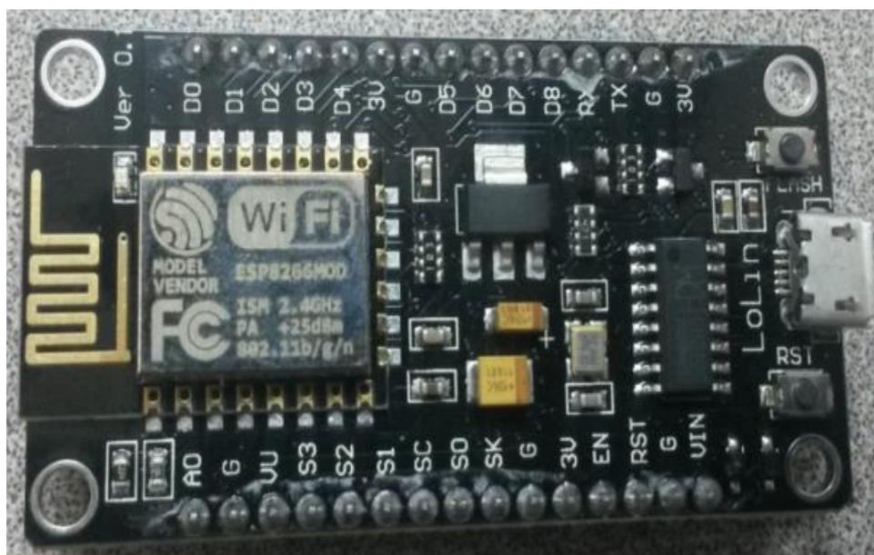
Figura 31. Módulo ESP8266(Los autores)
