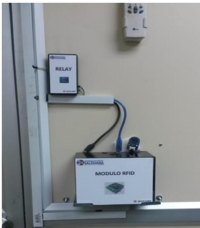
**Figura 88. Instalación del módulo de RFID(Los autores)**
