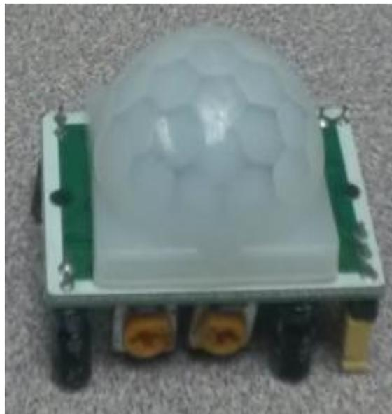
**Figura 17. Sensor de Movimiento HC-SR501(Los autores)**
