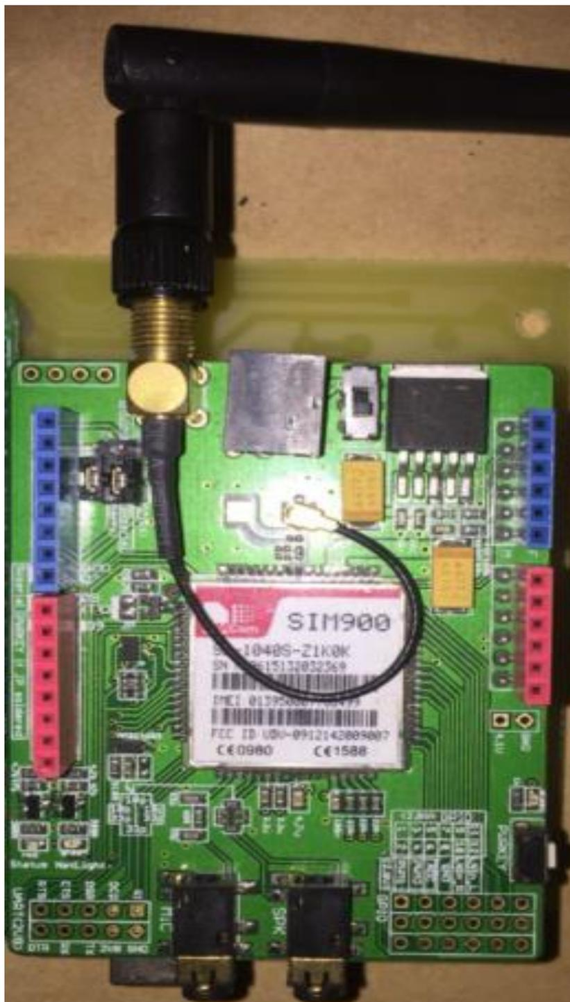
**Figura 32. Módulo Desarrollador Quad-band GPRS SIMCOM SIM900(Los autores)**
