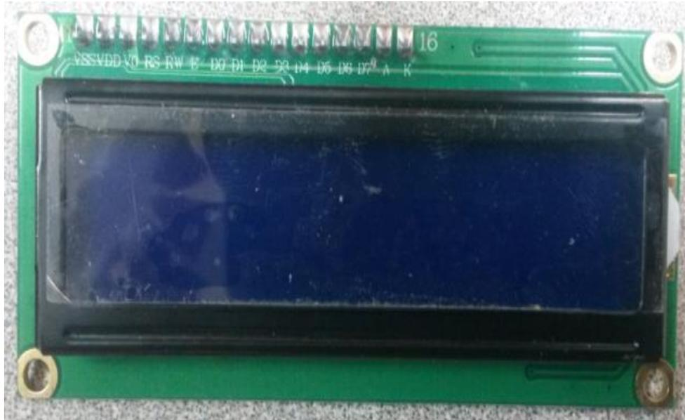
**Figura 29. Módulo LCD 16x2(Los autores)**
