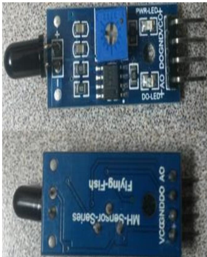
**Figura 15. Sensor de llama infrarrojo(Los autores)**
