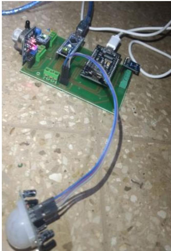
**Figura 80. Placa demódulo de movimiento, humo y luz(Los autores)**
